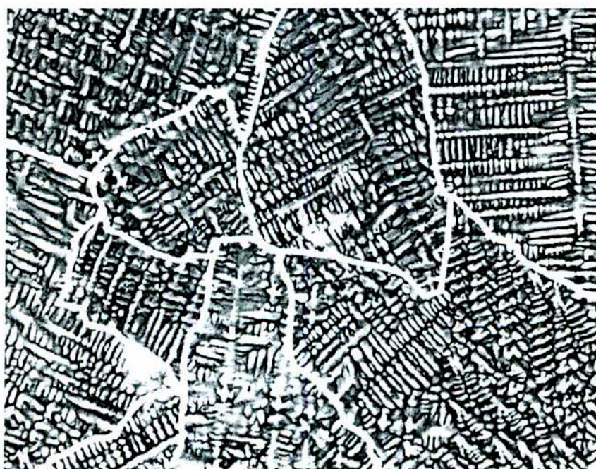
Figura 5.4: Estructura dendrítica característica de una partícula de Stellite policristalina, mostrando los bordes de grano (resaltados con trazos gruesos blancos)
