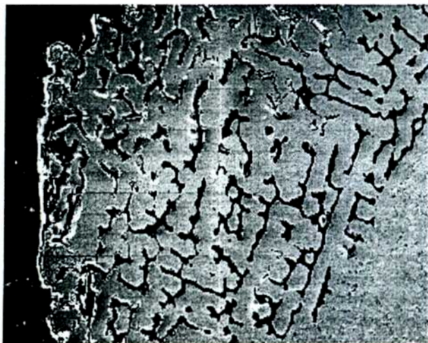
Figura 10.5: Borde del electrodo procesado mostrando el esqueleto dendrítico de la fase \gamma -Co, luego de la eyección del eutéctico interdendrítico. Micrografía SEM X 64.
