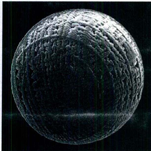
Figura 8.19: Estructura dendrítica de una partícula atomizada de 85 \mu\text{m} de diámetro, de la aleación C obtenida a una velocidad de giro 530 rps. Micrografía electrónica X 451
