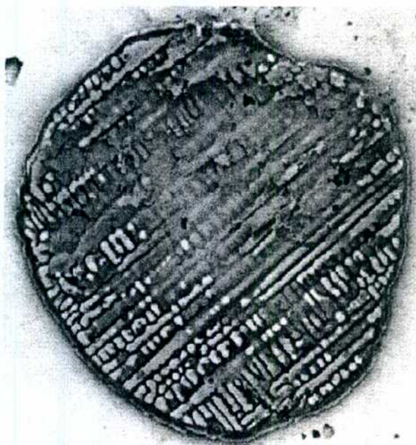
Figura 10.11: Microestructura "dendrítica" de una partícula del tipo B de 80 \mu\text{m} . La estructura está compuesta por dendritas primarias de la solución sólida de \gamma -Co con eutéctico interdendrítico ( \gamma -Co y carburos \text{M}_7\text{C}_3 ). Las dendritas primarias han crecido en una sola dirección en esta partícula "monocristalina". Micrografía SEM digital negativa.
