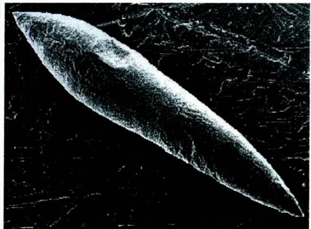
Figura 6.8: Ligamento desprendido de 274 μm de largo de una aleación Fe-31.6Mn-13.8Al-0.48C-0.17C (% en peso). Micrografía SEM X 361.
