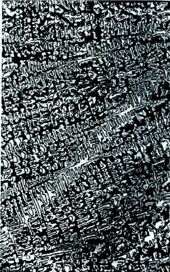
Figura 8.10: Estructura dendrítica de la aleación F colada. Las dendritas son austeníticas (zonas claras) con segregación ferrítica en los intersticios (zonas oscuras). Micrografía óptica X 75.
