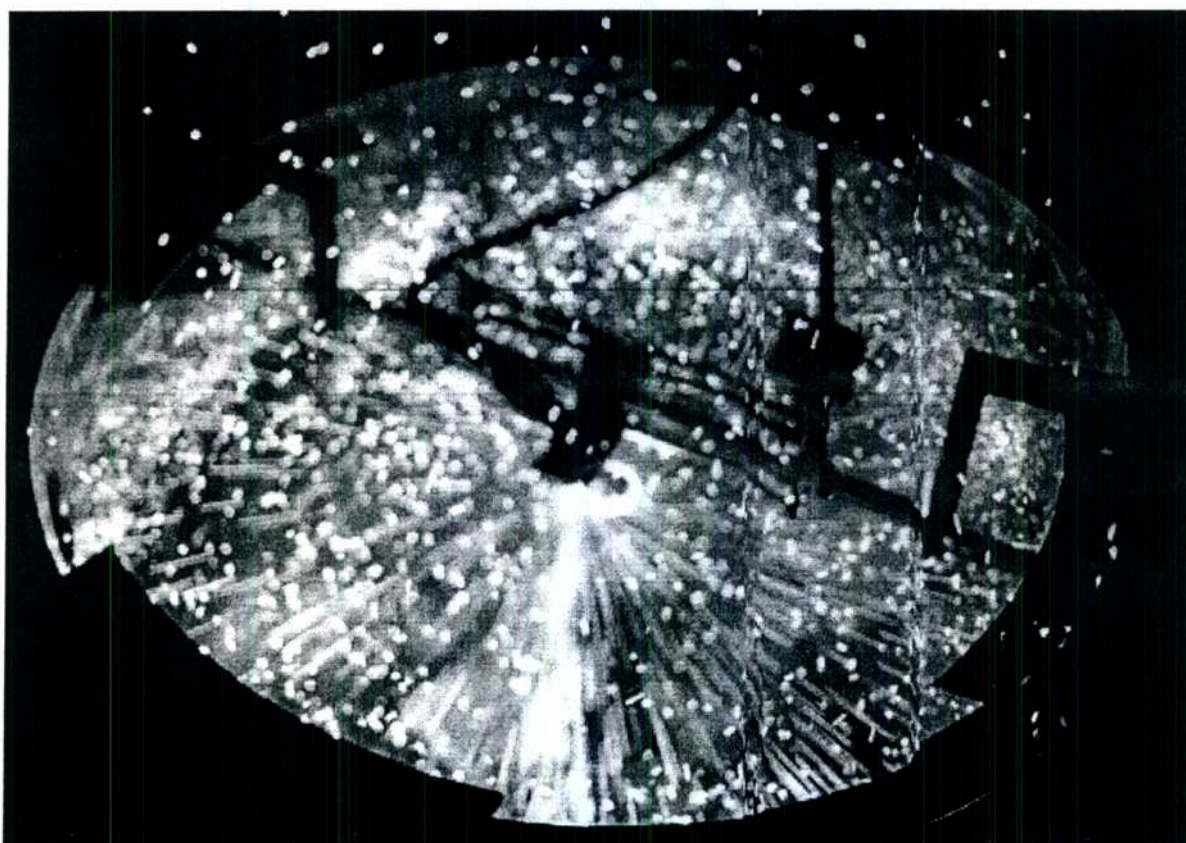
Figura 8.3: Distintos regímenes de producción de los aceros Fe-Mn-Al-C-Si por atomización empleando el plasma a 6 KVA (fotografía superior) y a 9 KVA (fotografía inferior) de potencia.
