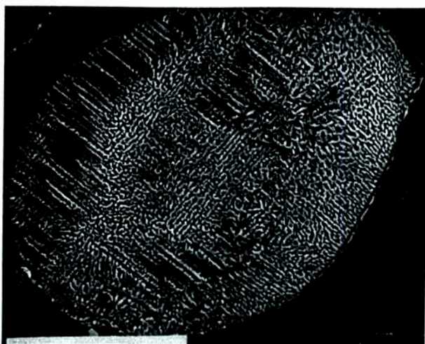
Figura 8.26: Estructura dendrítica de una partícula, de 223 \mu\text{m} , austenítico-ferrítica de la aleación F. Micrografía SEM X.
