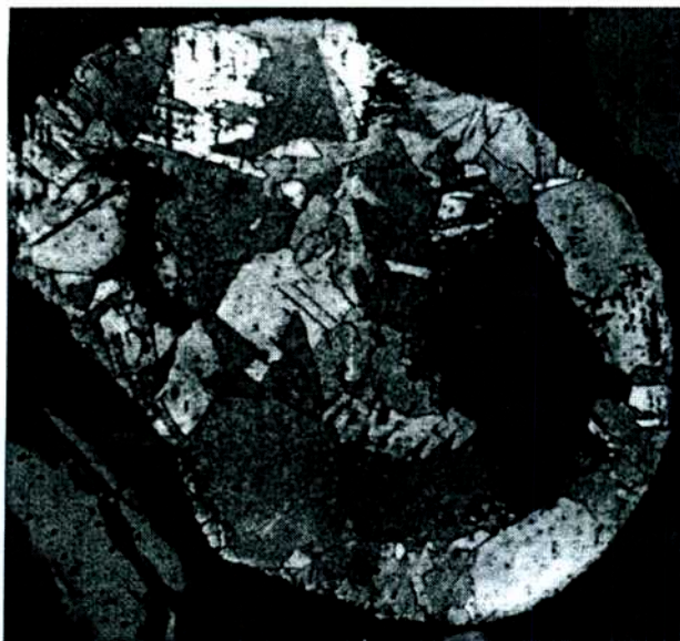
Figura 8.22: Partícula policristalina completamente austenítica de la aleación B. Micrografía óptica X 486
