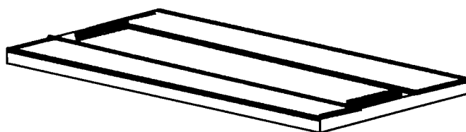
Plancha de metacrilato, con topes móviles en los extremos sobre la cual se vierte el gel de almidón.
