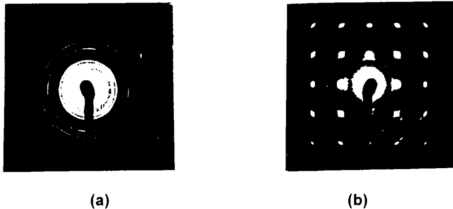
Figura 3.2: Diagramas de difracción de Ag obtenida sobre sustratos sin calentar por (a): e-v; (b): t-i-p
