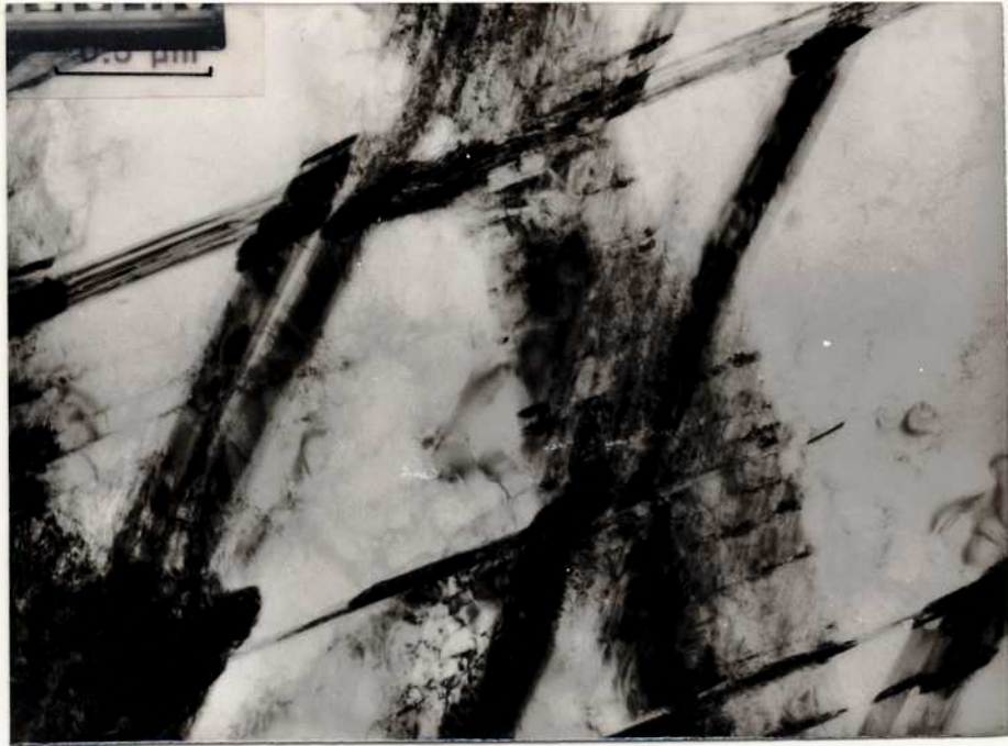
Fig. V-4: Arreglo típico de dislocaciones para deslizamiento planar, presente en la aleación III que posee el menor valor de energía de falla de apilamiento entre las aleaciones estudiadas.
