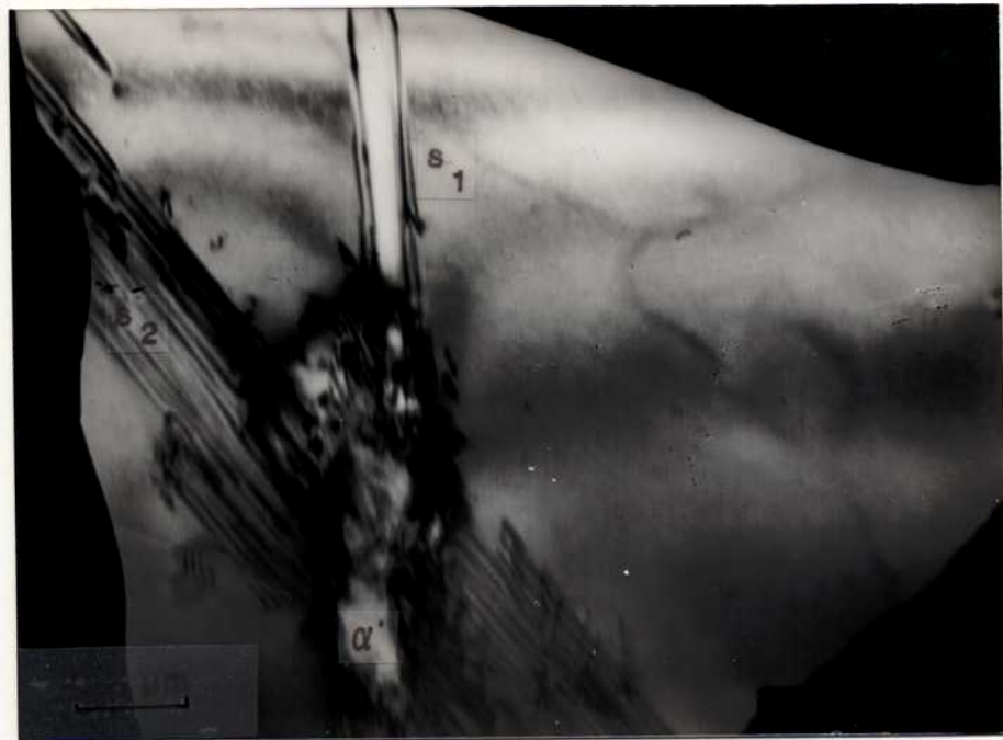
Fig. V-6: Nucleación de la martensita \alpha' inducida por la intersección de un plano activo de deslizamiento s_1 con una banda de deslizamiento s_2 , en las aleaciones I y II laminadas hasta el 5% de reducción.
