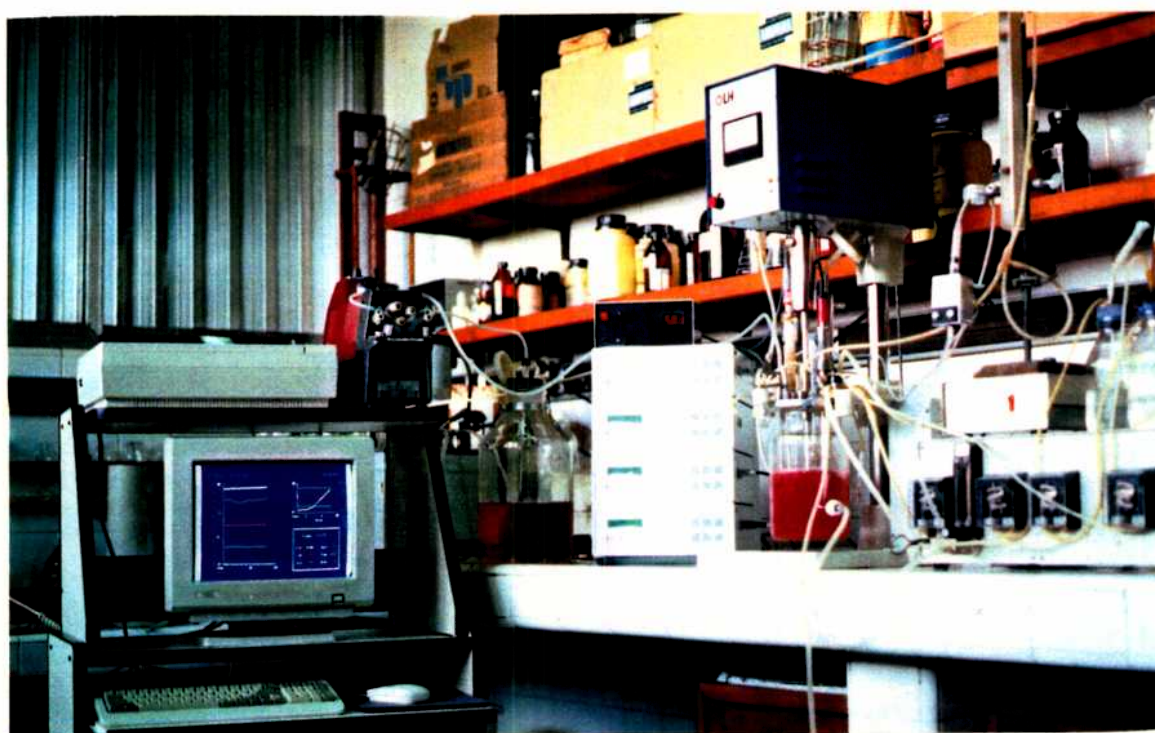
FOTO 8: Fermentador LH 502D conectado a una computadora AT-386 y corriendo Biofer 3.0.
