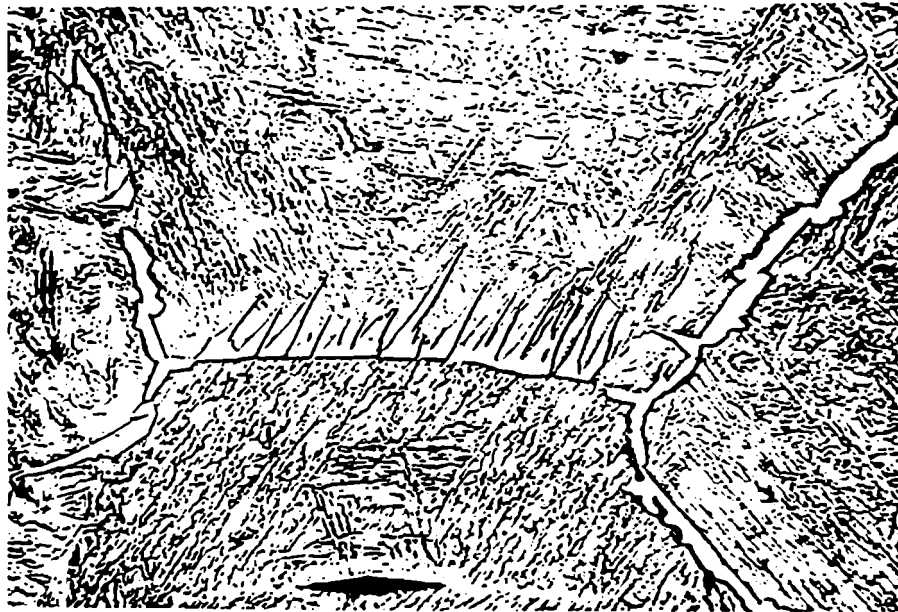
Figura 1.16: Ferrita nucleada en bordes de grano de la austenita [SHE69]
