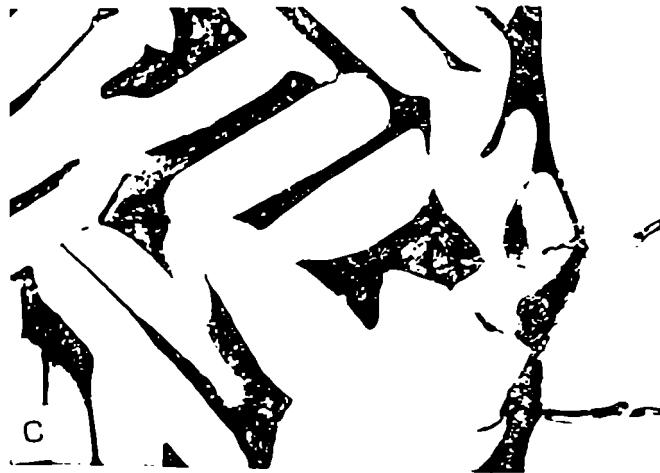
Figura 1.24: Zr-2.5% Nb. Tratamiento: 1h a 1050°C, luego 180 días a 770°C. Micrografías ópticas. Fase clara: \alpha . fase oscura: \beta previa. a) M=60X, luz normal. b) M=200X, luz polarizada. c) M=500X, luz normal.
