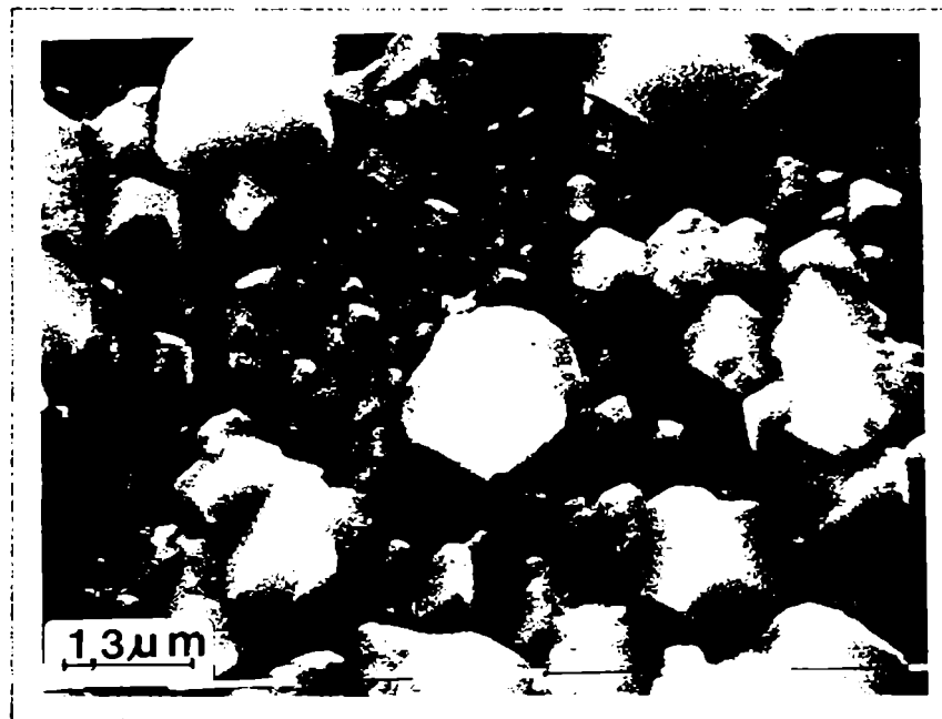
Figura 17: otra zona de la película crecida hidrotérmicamente en hierro puro durante 770 hs
