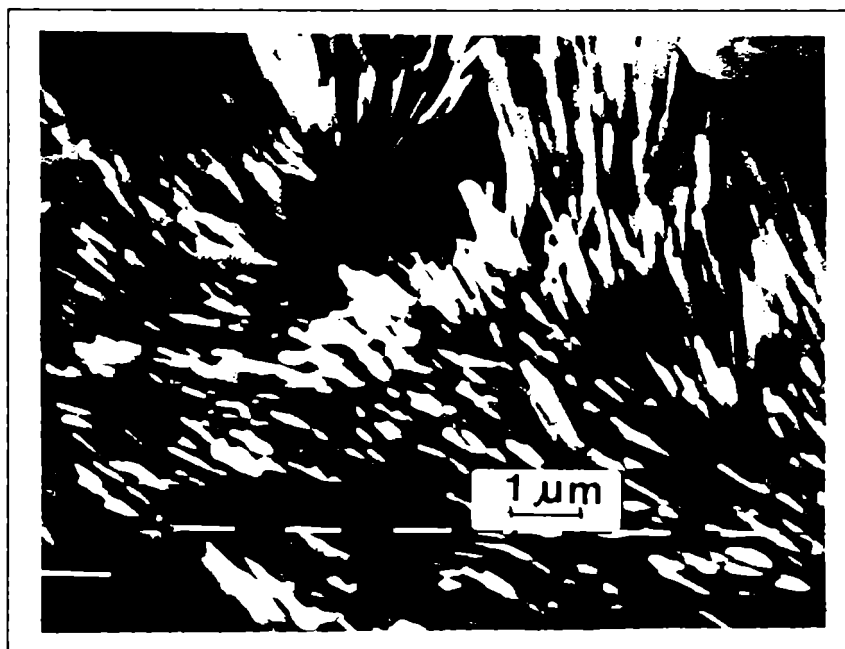
Figura 5: magnificación de otra zona de la parte externa de la cascarilla de óxido.
