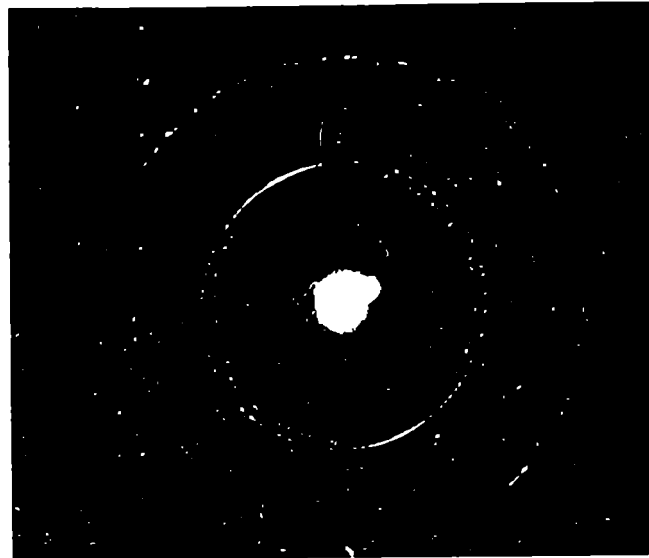
Figura 9: diagrama de difracción de electrones de la cara externa de la cascarilla crecida a 800 °C
