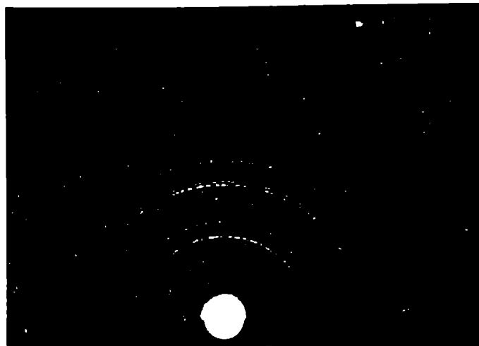
Figura 38: diagrama de difracción de electrones para la película crecida durante 1970 hs.
