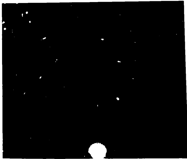
Figura 3: diagrama de difracción de electrones rasantes correspondiente a la superficie de la lámina de hierro puro electropulida.
