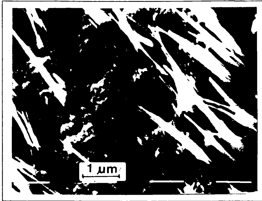
Figura 4: magnificación de una zona de la parte externa de la cascarilla de óxido, donde se observan las agujas y la superficie ondulada de hematita.
