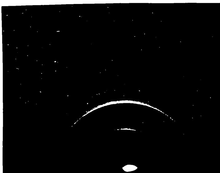
Figura 33 : diagrama de difracción de electrones de la película crecida durante 410 hs, 75 keV.
