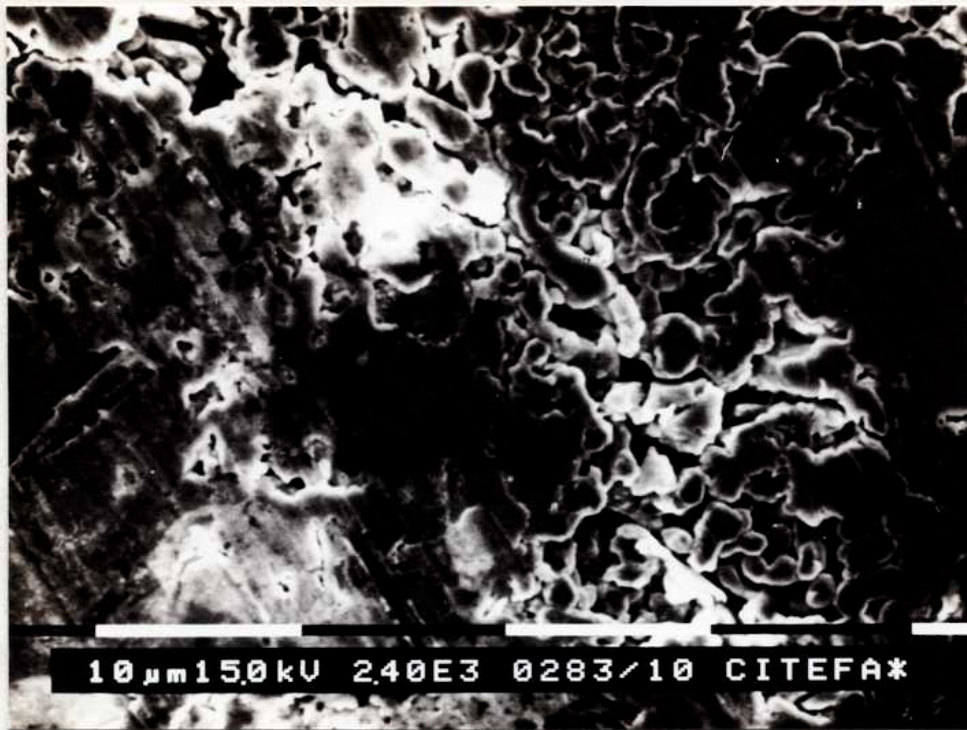
Foto 9.- Superficie de electrodo compactado. Mezcla 50/50 % en peso de Ag y electrolito (240X).
