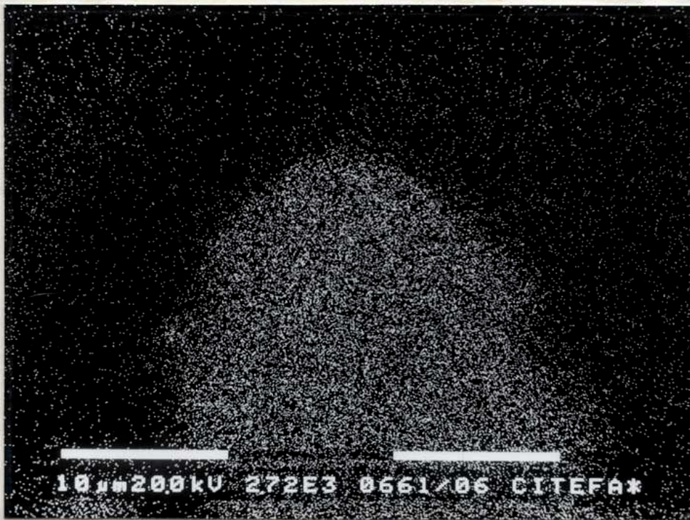
Foto 21.- Mapeo de Ag en una zona ampliada de la foto 20.
