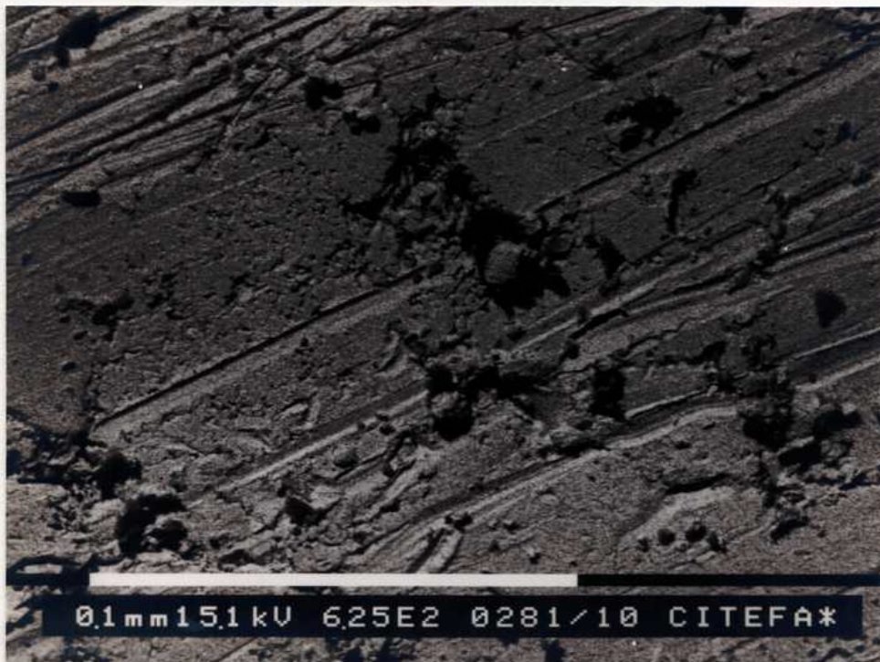
Foto 10.- Superficie pulida de electrodo compactado, mezcla 50/50% en peso de Ag y electrolito (625X).
