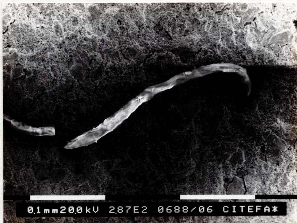
Foto 13.- Dendrita de Ag. obtenida en el Electrodo de Grafito. Se muestra la zona central del electrodo al desmenuarse. Diferencia de potencial aplicada: 0.1 V.
