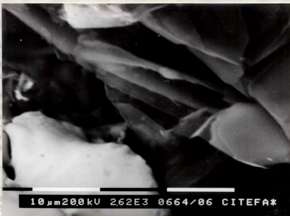
Foto 23.- Zona de la interfase sin contacto entre el electrolito y el grafito.
