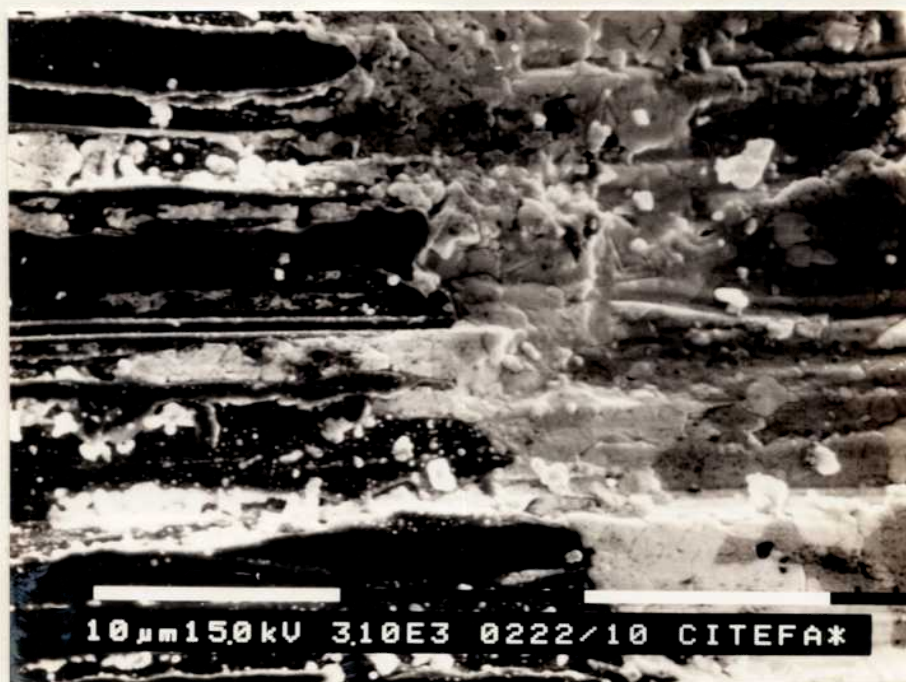
Figura 2.17.b.- El mismo electrodo de la figura 2.17.a. Aumentos 3100X. Zona oscura: polvo de plata, zona clara: electrolito
