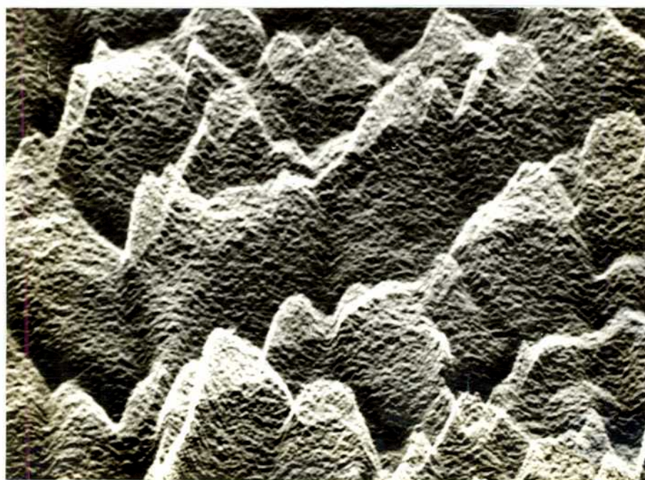
Figura 4.57.- Fotografía obtenida por microscopía electrónica de barrido de chapa de plata. Aumentos 32000 X.
