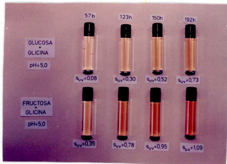
Figura 16 : Aspecto que presentan las soluciones de glucosa o fructosa con glicina de pH = 5 tratadas a 55°C durante diferentes períodos de tiempo
