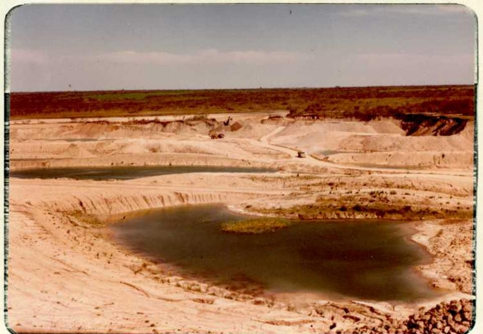
FOTO Nº 18.-Cantera arroyo Las Piedras en el yacimiento Las Piedras. Zona explotada cubierta por lagunas vista desde la pila del material estéril de unos 20 metros de altura.
