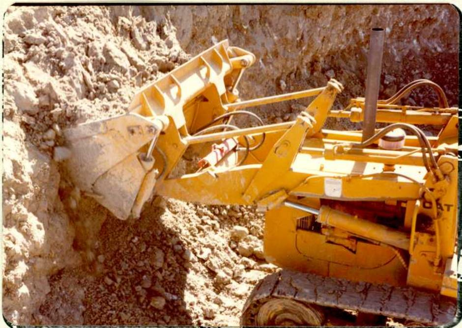
FOTO N° 15.- Cantera San Luis en el yacimiento San Luis. Explotación mixta por ataque del frente de cantera con pala mecánica y selección manual del mineral de yeso.
