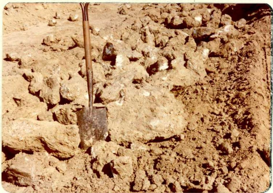
FOTOS Nº 13 y 14.- Cantera San Luis en el yacimiento San Luis. Explotación semimecanizada del banco yesífero por rebaje, el yeso es seleccionado manualmente. En la toma de abajo se puede observar el mineral de yeso en pilas donde se produce una concentración primaria en cantera por desecación y desprendimiento del material arcilloso.-
