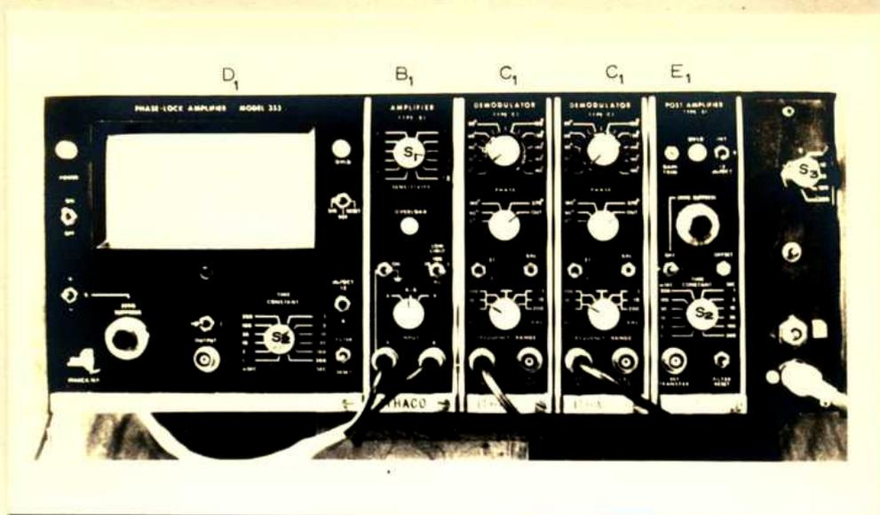
Figura 13. Detector sensible a fase Ithaco 353.
