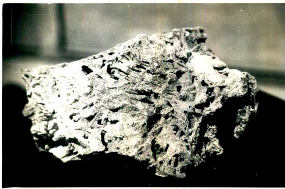
、 Fig.12 :-La Helvecia Típico trozo de calamina."Boxwork" según blenda
