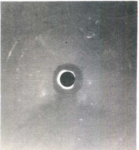
Fig. 23- a) diagrama de un mono cristal exagonal (plano basal a proximadamente perpendicular al haz de rayos X. b) Idem después de 20 min. de calentamiento a 80°C. c) después de 60 min. d) después de 100 min. e) después de 130 min. f) las mismas condiciones de e) rotada la muestra 10° en el sentido de las agujas del reloj. g) Idem 20° h) Idem 30°. i) las mismas condiciones de e) pero rotada 10° en sentido contrario a las agujas del reloj. J) Idem 20°. k) Idem 30°.
