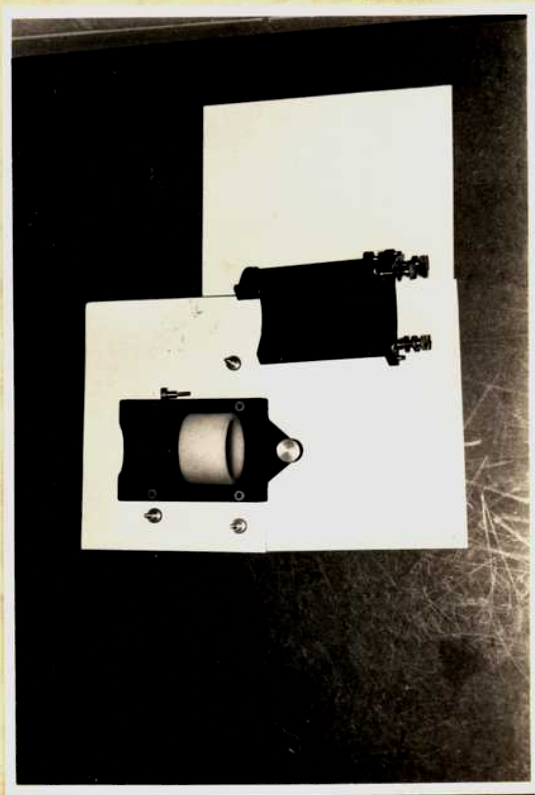
Fig. VI - f - 2 - 6. Fotografía del montaje Hilger y del espaciador de 5 cm dñl interferómetro de Fabry-Perot.
