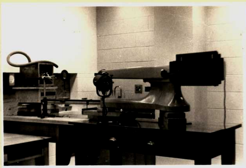
Fig. VI - f - 2 - 5. Fotografía del espectrógrafo Hilger mediano con óptica de cuarzo, que se usó para cruzar al interferómetro de Fabry-Perot.
