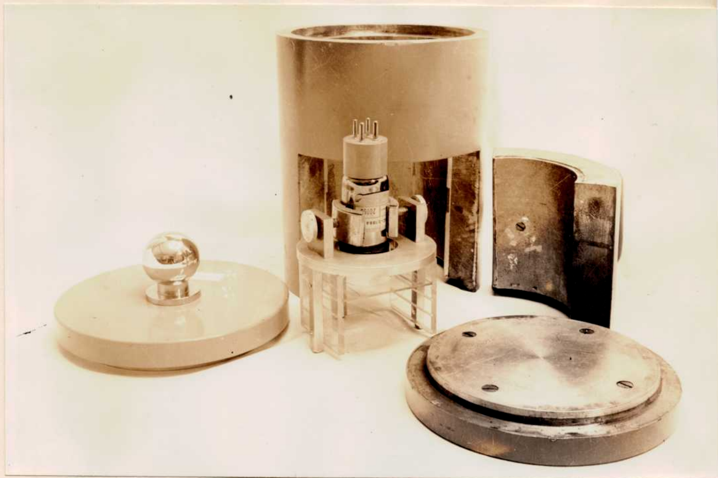
Fig. 1.- Tubo contador colocado en la caja soporte y piezas que componen el castillo de plomo.-
