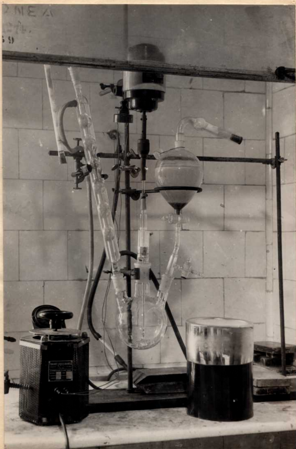
ILUSTRACION Nº 10 : REACTOR PARA LA PREPARACION DE COMPUESTOS ORGANOMETALICOS
