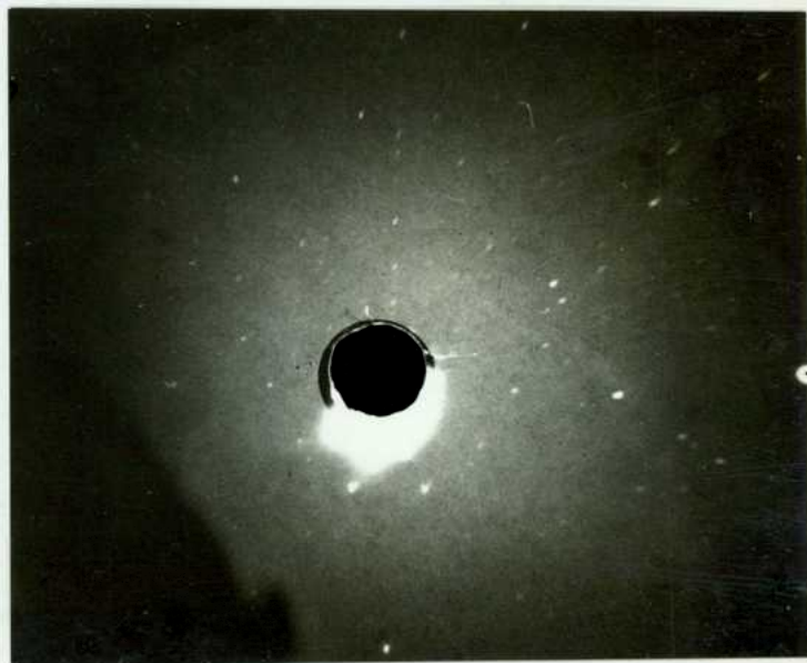
Fig.No.7.- Diagrama de Laue mostrando eje de simetría cuaternaria.
