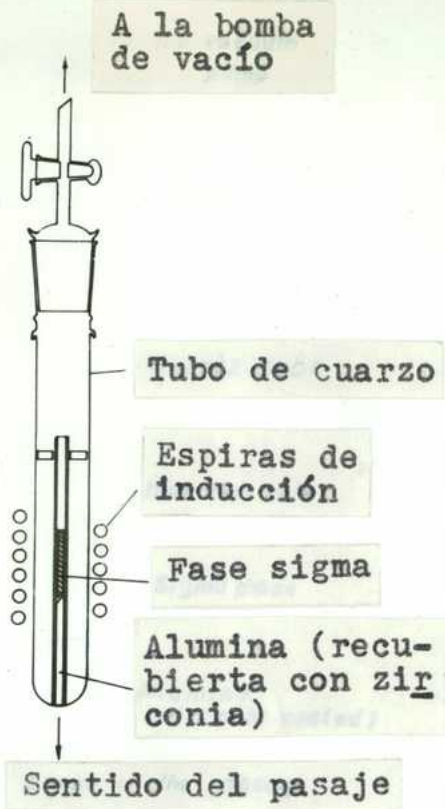
Fig.No.8.- Sistema de crecimiento por horno de inducción
