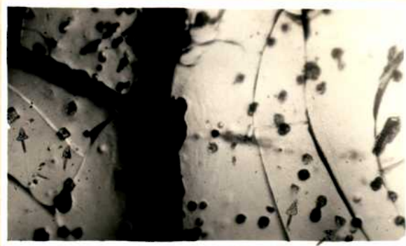
Fig.35-Prob.N 66, corr. 18 hs. a 200°C.Oxido desprendido con metanol iodado, y observado por transparencia.Las flechas muestran los cuadrados y triángulos mencionados en el texto.(100X).
