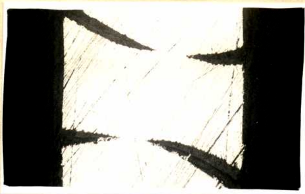
Fig.28-Prob.N 68, corr. 18 hs. a 200°C. Rajaduras del óxido a lo largo del límite de grano, (pulido mecánico) (60X).
