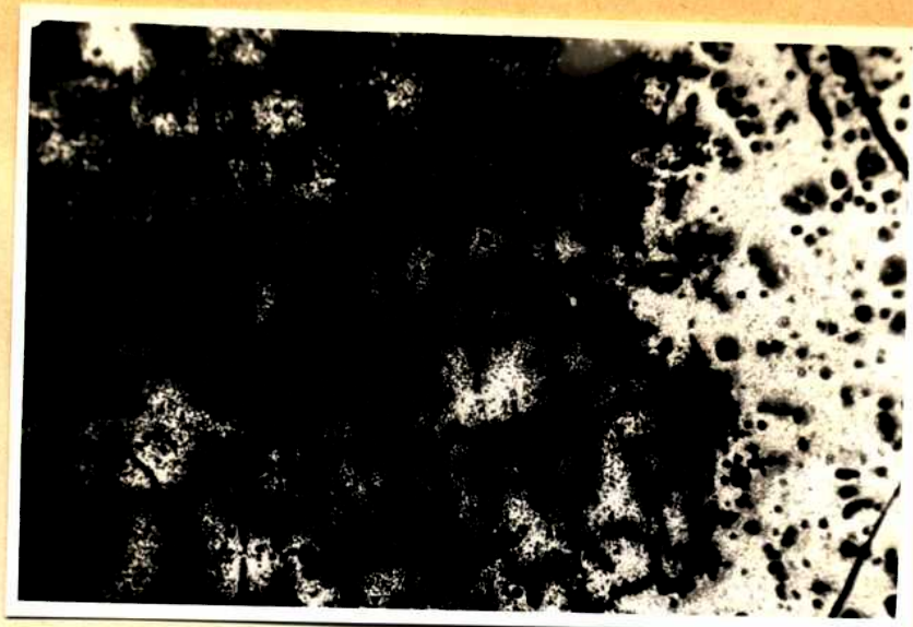
Fig.48-Probeta 0 5.Al-300 ppm Ni. Corroída 14 días a 200°C. Extensión de la capa oscura. (100X).
