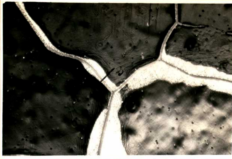
Fig.33-Prob. N 127,corr.aprox.14 hs. a 200°C. Decapada superficialmente con polvo de diamante. Zonas blancas: aluminio al descubierto. Zonas oscuras: aluminio preoxidado.Tomada con luz polarizada, cada grano presenta un tono distinto. Arriba centro se observan líneas que serían de "slip".(50X).
