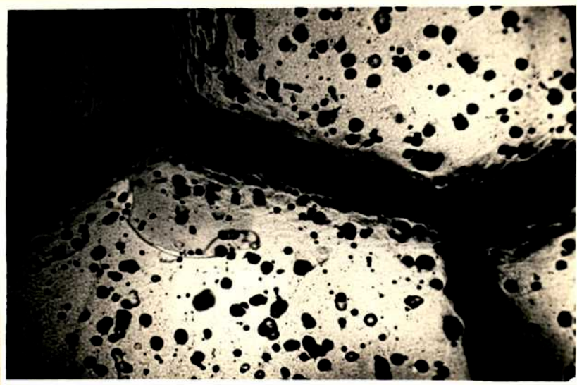
Fig.23-Prob. N 187, corr. 4 hs. a 225°C.Centro: límite muy atacado, de borde liso.La flecha indica una escama de óxido a punto de desprenderse.(100X).
