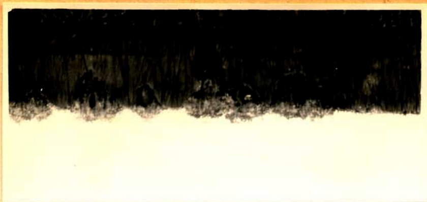
Fig.40-Prob.N 223, corr. 190 hs. a 175°C. Comienzo de ataque localizado.(250X).
