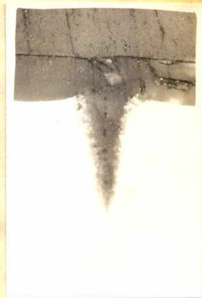
Fig.43-Prob.N 88 corr.26 hs. a 200°C.Límite de grano poco atacado.Burbujas en el óxido a lo largo del límite.(250X).
