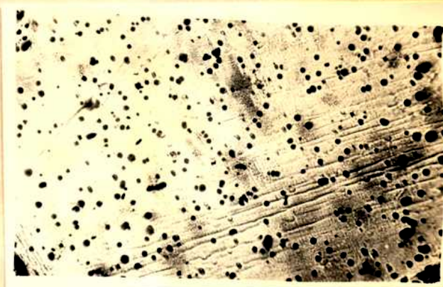
Fig.39-Prob.N 75, corr. 8 hs. a 200°C. Líneas observadas en la superficie del Al corroído. Probablemente "slip". (50X).
