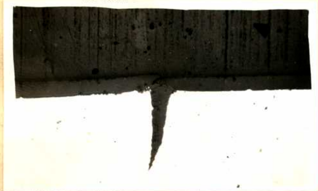
Fig.42-Prob.N 88, corr.26 hs. a 200°C. (Corte)Interfase metal-óxido lisa.(100X).
