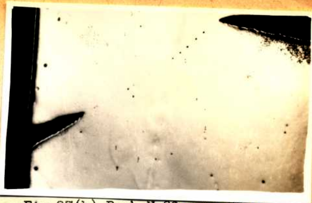
Fig.27(b)-Prob.N 89, corr.26 hs. a 200°C. Burbujas a lo largo de un límite de grano. (100X).
