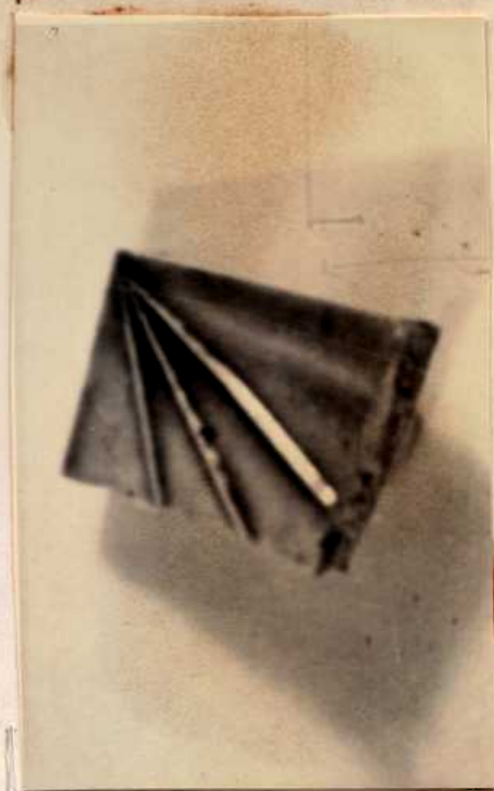
Muestra de la Exp. nº 105 b. en la que se ensayó el ba- salto fundido como esmalte vitrificable.
