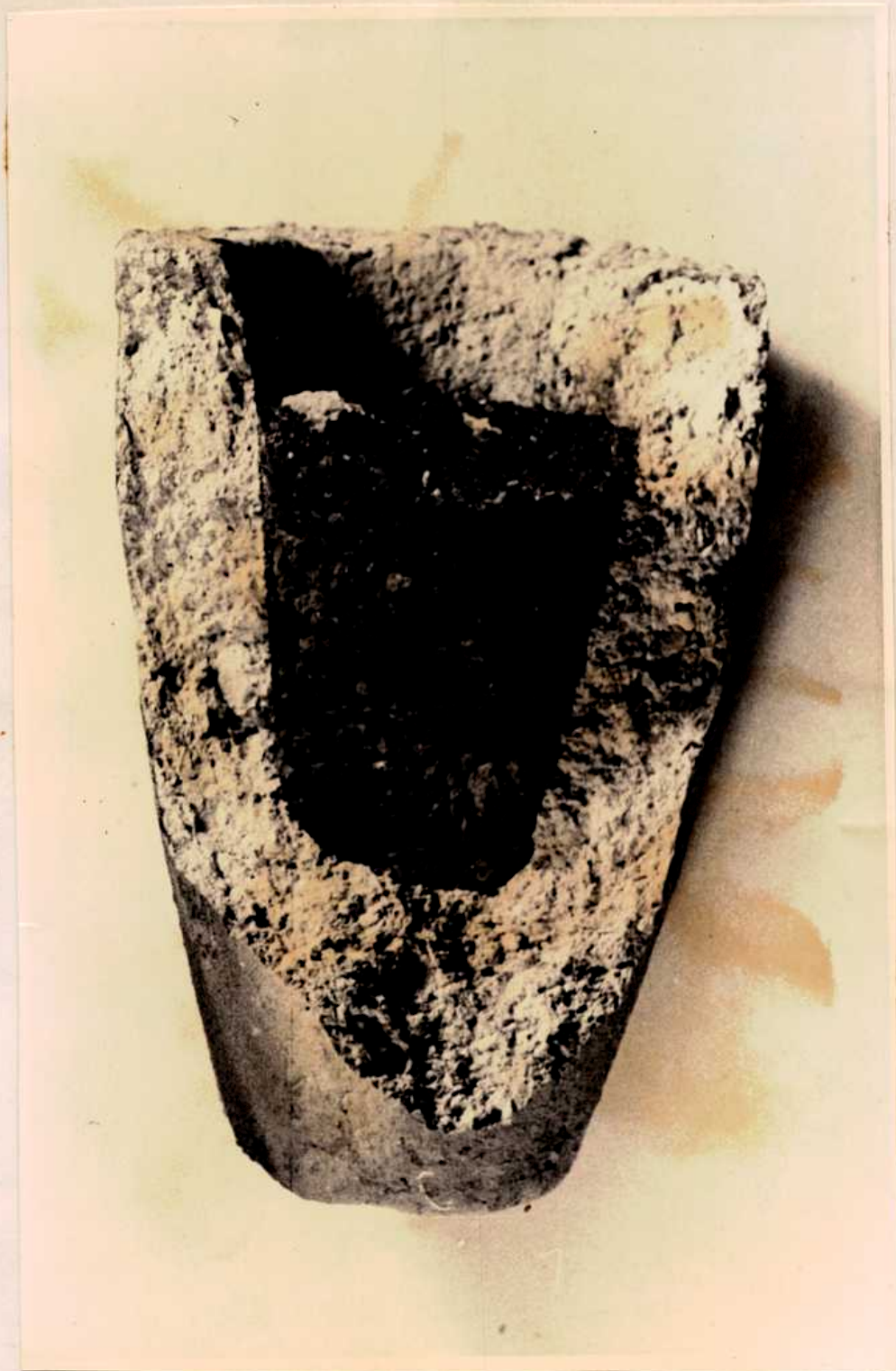
Experiencia nº. 103. Crisol conteniendo basalto que no fundió.
