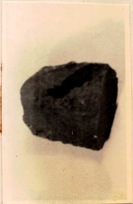
Experiencia nº 79 Basalto fundido. Fundente Carbonato de Calcio Se observa el canal provoca- do por el desplazamiento de gases.
