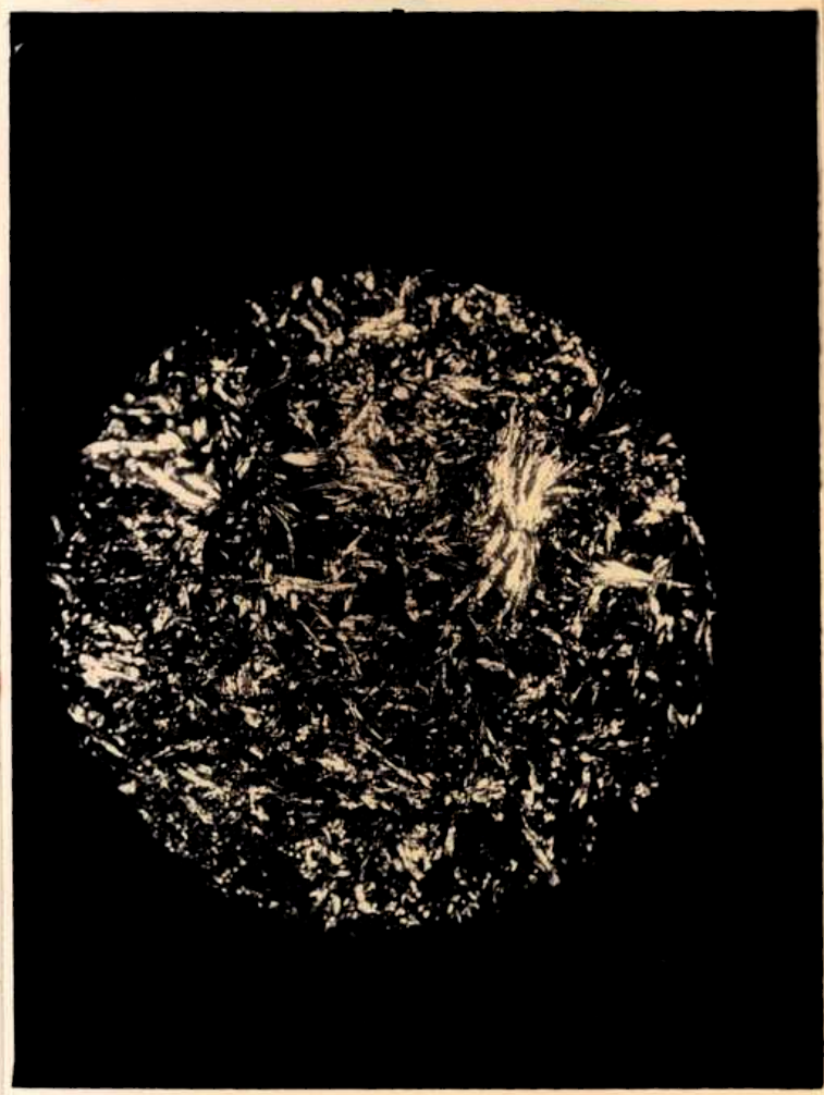
Experiencia nº 77 - Preparado microscópico Basalto desvitrificado por enfriamiento lento. Nicols cruzados x 60.
