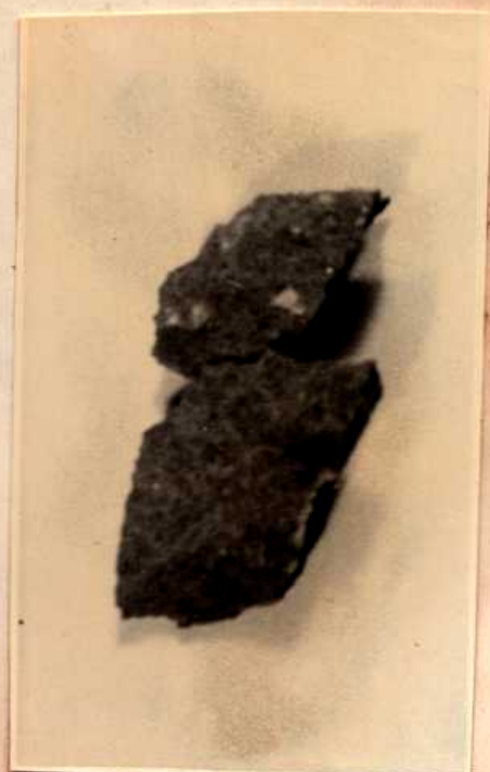
Basalto fundido y desvitrifi cado. Fundente \text{CaF}_2 de GINO.
