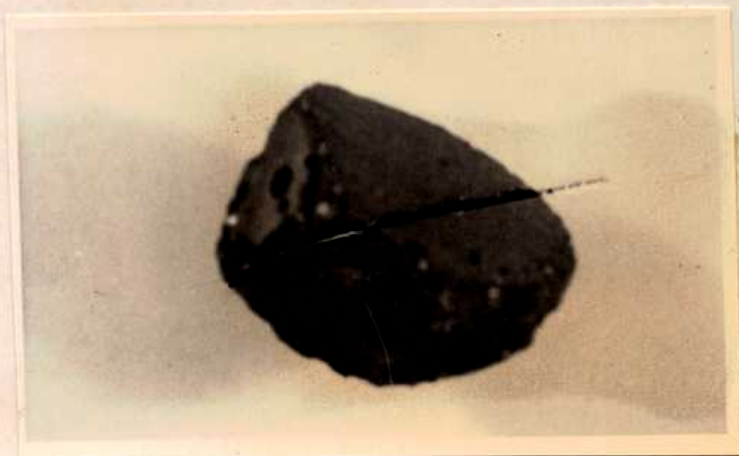
Experiencia nº 77 Masa de Basalto fundido y desvitrificado. Fundente Fluorita.
