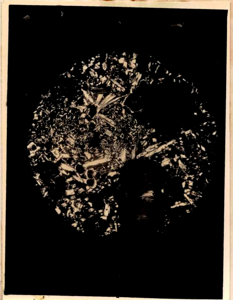
Experiencia nº 86 -Preparado microscópico. Basalto recristalizado. Se observan restos no identificables de la roca original. Nícoles cruzados x 60.
