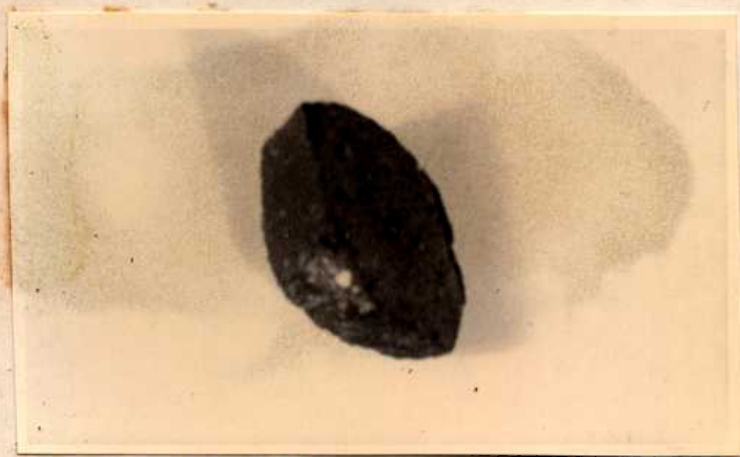
Experiencia nº 100 Basalto fundido y desvitrificado. Fundente Carbonato de Bario.
