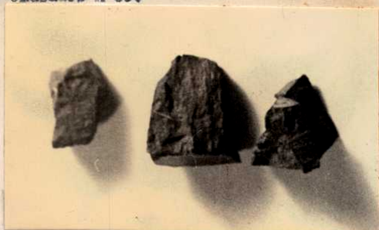
Experiencia nº 94 Basalto fundido y desvitrificado Fundente Bórax.
