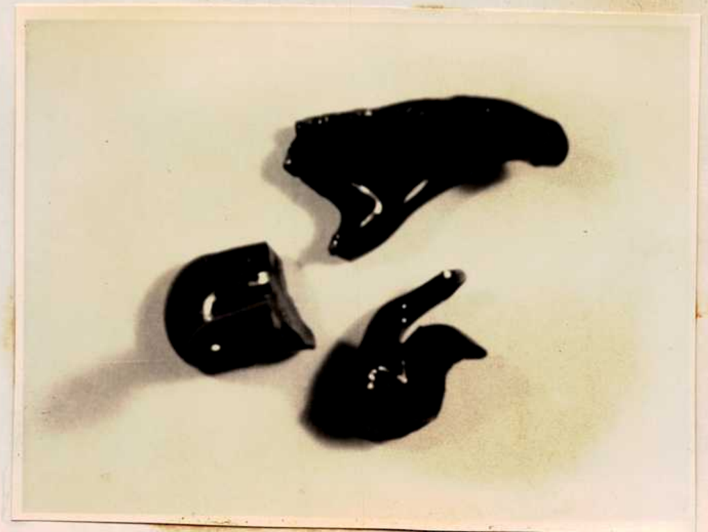
Vidrio basáltico moldeado obtenido en la Exp.nº 105.
