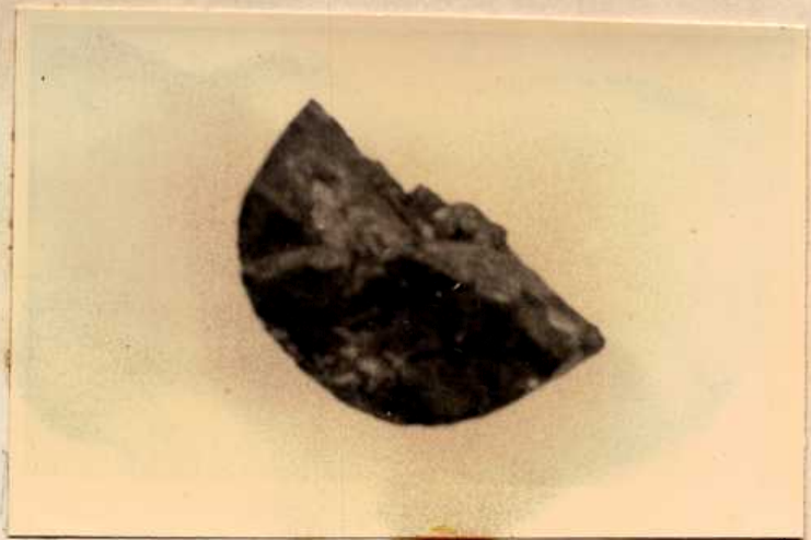
Experiencia nº 86 Basalto fundido y desvitrificado. Fundente Carbonato de Calcio.
