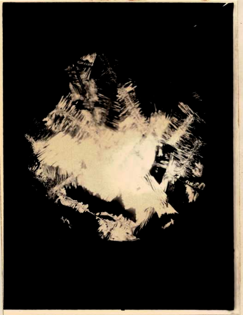
Experiencia nº 55-Preparado microscópico Vidrio negro de estructura plumílica en partes desvitrificado. Nícoles cruzados x 20.
