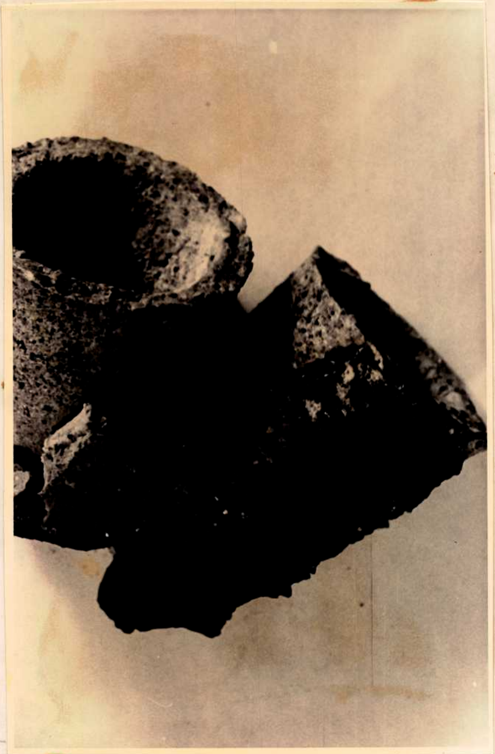
Crisoles en los que el material fundido atravesó las paredes.
