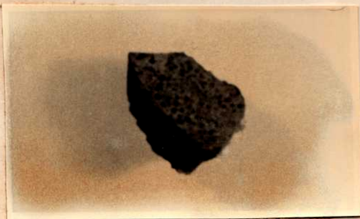
Basalto fundido, parcialmente desvitrifi cado. Fundente: \text{BaCO}_3 .
