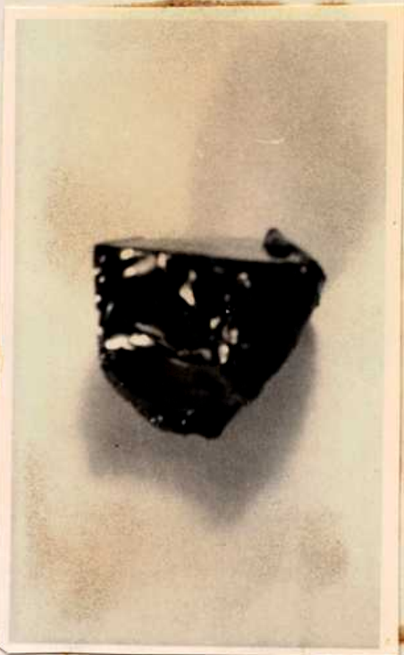
Vidrio basáltico obtenido en la Exp.nº 44. Fundente Carbonato de Calcio
