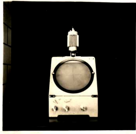
"Fibrómetro" microscopio con proyector para determinar finura de la lana.
