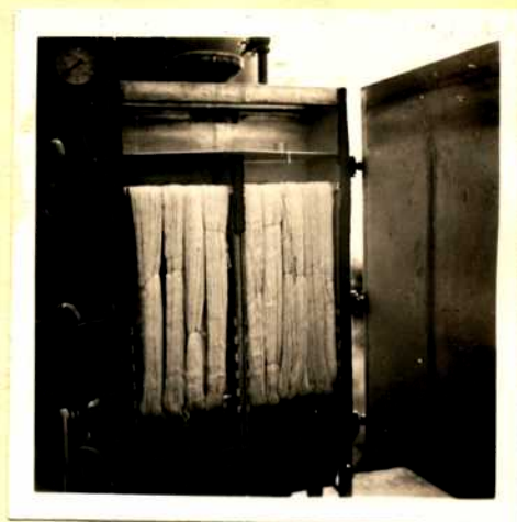
El mismo aparato abierto mostrando como se cargan las madejas
