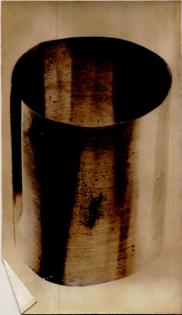
FIG.2-a Cinta donde se puede apreciar el defecto aparecido al ser cilindrada.
