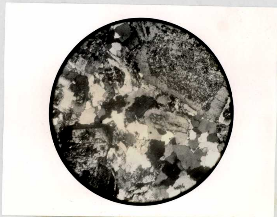
Microfot. N° 11. Microgranodiorita. Se observa que los individuos de plagioclasa tienen mayor tamaño que los otros componentes, están alterados y poseen estructura zonal. Muestra de la quebrada de Las Trancas.- Nicoles cruzados, n° 23.
