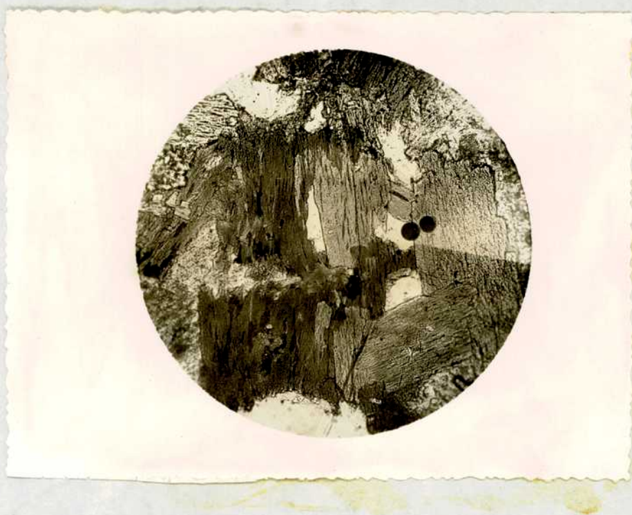
Microfot. N° 7.- Tonalita. Se observa el reemplazamiento de cristales de hornblenda por biotita. Muestra del Puesto de Aspajos. Luz paral. x 70.-
