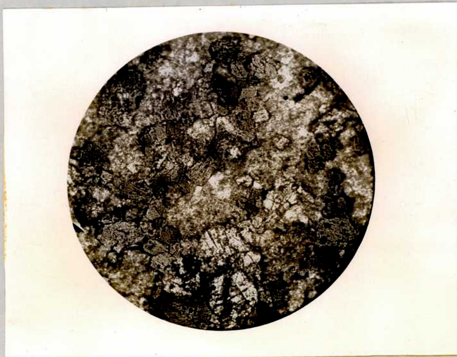
Microfot. N° 2. Hornfels bandeado oligoclásico cuarzoso hornblendífero diopsídico. Se ven alternar las banditas hornblendíferas con otras cuarzosa-oligoclásicas. Muestra del Portezuelo de Santa Rosa. Luz paral., x 23.-
