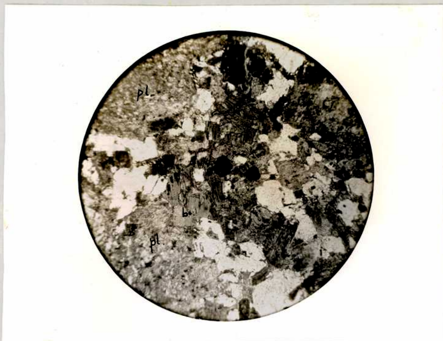
Microfot. N° 6; Granito hornblendífero biotítico. pl; albioligoclasa alterada; o; ortosa caolinizada; H; hornblenda; b; biotita cloritizada; m; magnetita.- Muestra de la quebrada de la Casa Colorada. Luz paral. x 23.-
