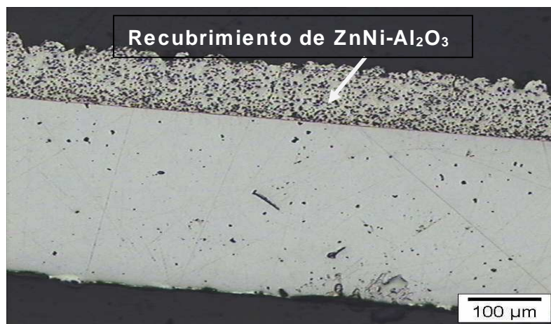
Figura 3: Sección transversal del recubrimiento de ZnNi con partículas de \text{Al}_2\text{O}_3 .
