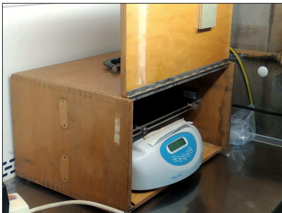
Figura 2M: Sistema utilizado para el ensayo de exposición a radiación UV-C.
