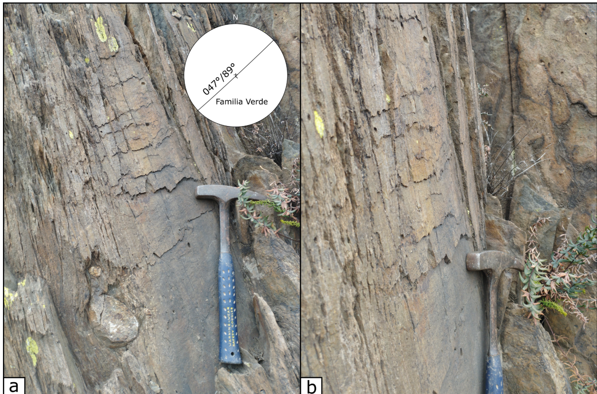
Figura 4.18: Fractura representativa de la familia verde ( 047^\circ/89^\circ ) con escalones visibles a lo largo del plano de fractura. a) Vista frontal, donde se observa la superficie escalonada del plano; b) Vista lateral, con la piqueta utilizada como escala. El estereograma muestra la orientación promedio de esta familia en la estación correspondiente (ver ubicación en figura 2.1).
