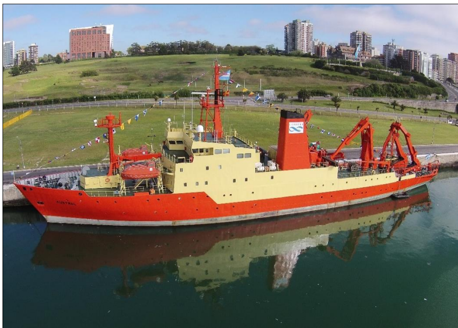
Figura 3.1. El buque oceanográfico ARA Austral fue construido en Alemania como una embarcación pesquera, donde lo bautizaron Sonne y botaron en 1968. En 1977 lo adquirió RF Reedereigemeinschaft Forschungsschiffahrt y fue reformado como un buque de investigación científica. En 2014 fue retirado y puesto a la venta. Ese mismo año lo inspeccionó un equipo de CONICET, y arribó a la Base Naval de Mar del Plata en febrero de 2015 para ser oficialmente incorporado dentro la iniciativa Pampa Azul. El BOA posee una eslora de 97,61 m, una manga de 14,2 m, capacidad para 25 científicos y 25 tripulantes, y una autonomía de operación de 50 días ( https://www.argentina.gob.ar/armada/superficie/idades/buque-oceanografico-ara-austral-q-21 ).
