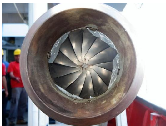
Figura 3.5. Válvula de retención montada en el interior de la boquilla de corte en la base del sacatestigos.
