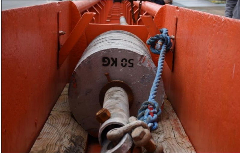
Figura 3.3. Cabezal del sacatestigos con discos de 50 kg.
