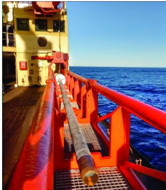
Figura 3.4. Equipo de sacatestigos por gravedad con cabezal, tubos de acero y boquilla de corte.
