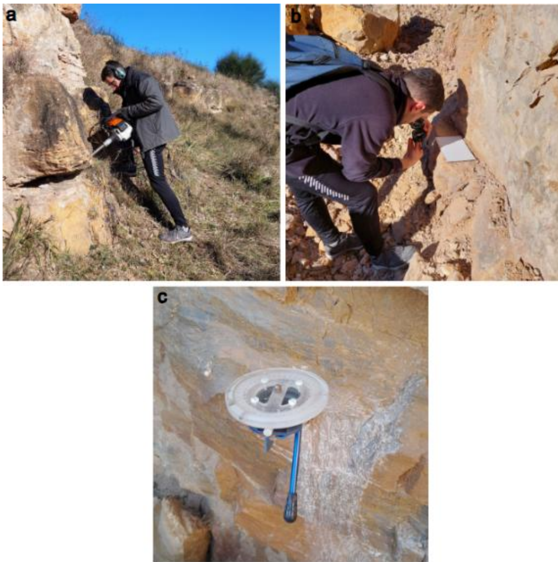
Figura 8. a. Perforación para extracción de muestra con motosierra. b. Toma de datos de actitud del banco del cual se extrajo la muestra. c. Orientador.
