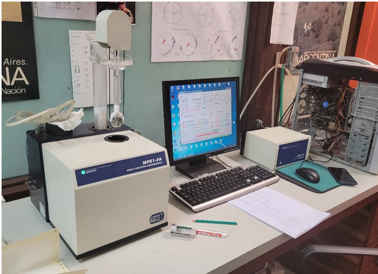
Figura 5.2.4.: Equipamiento utilizado para la medición de la susceptibilidad magnética. Susceptibilímetro AGICO (modelo MFK1-A).
