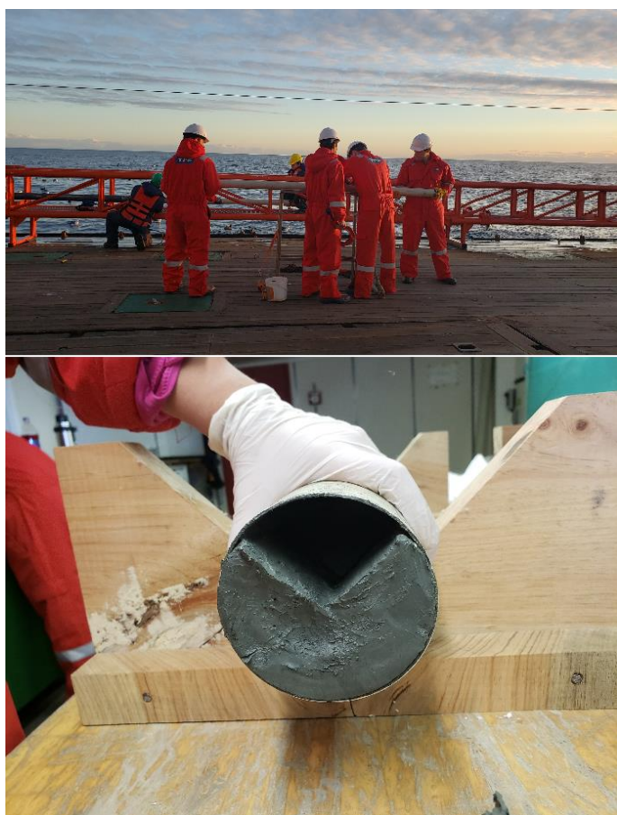
Fig. 15. Arriba: maniobra de corte de portatestigo en la cubierta del BOA. Abajo: fotografía del interior de un testigo.
