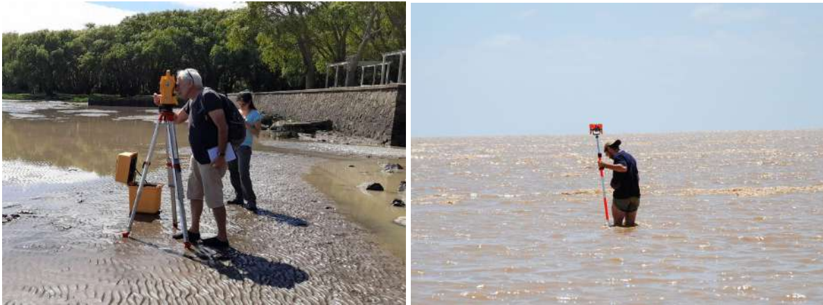
Figura 2.1: Relevamiento topográfico con estación total.
