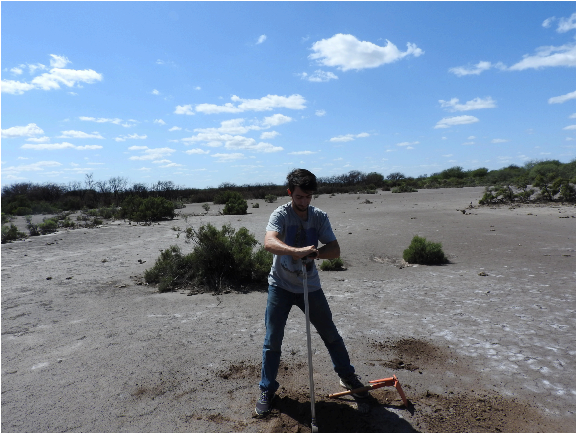
Figura 5.9. Parada MLP7 donde se realiza el muestreo manual con un barreno.
