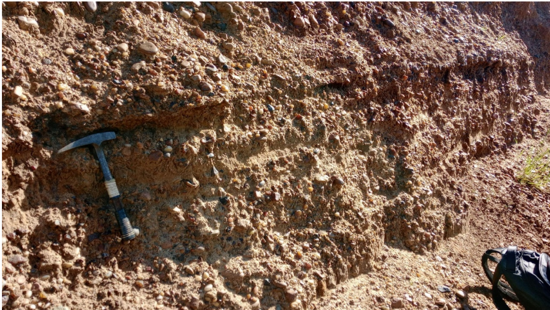
Figura 11. Afloramiento de la Formación Salto Chico en Cantera Scévola (-58,00101W y -31,31882S), Villa Zorroaqué, Concordia. Puede observarse la presencia de material clástico tamaño grava media a gruesa intercala con arena gruesa.
