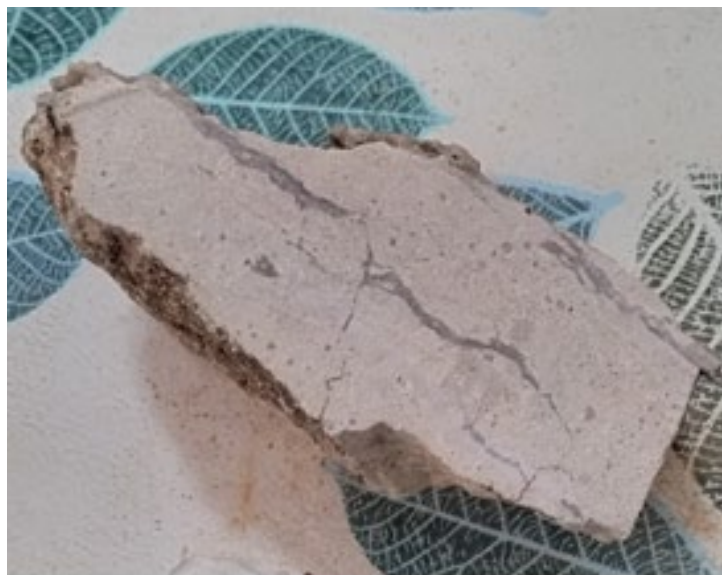
Figura 10. Muestra de la Formación Puerto Yeruá, corte y pulido, donde se observan venas de cuarzo.
