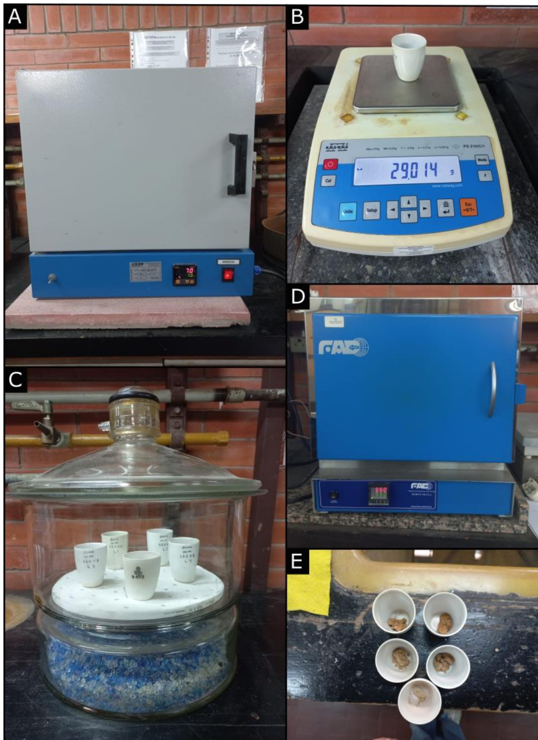
Figura 13: Procedimiento para realizar el ensayo Loss of Ignition . A) Estufa de secado. B) Balanza de precisión. C) Crisoles colocados en el desecador. D) Mufla. E) Muestra sin materia orgánica luego de finalizar el ensayo.
