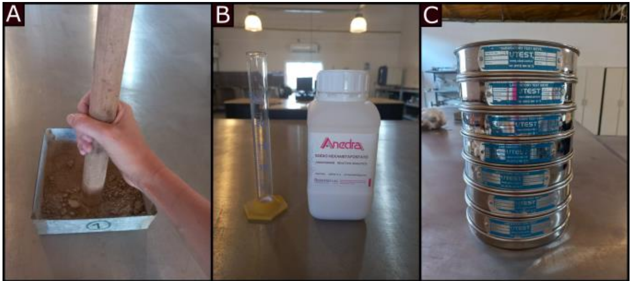
Figura 7: Metodología utilizada para el ensayo de granulometría. A) Proceso de desagregación de muestras con mortero de madera. B) Solución antifloculante sodio hexametáfosfato. C) Tamices utilizados para la separación mecánica de las partículas según su tamaño.
