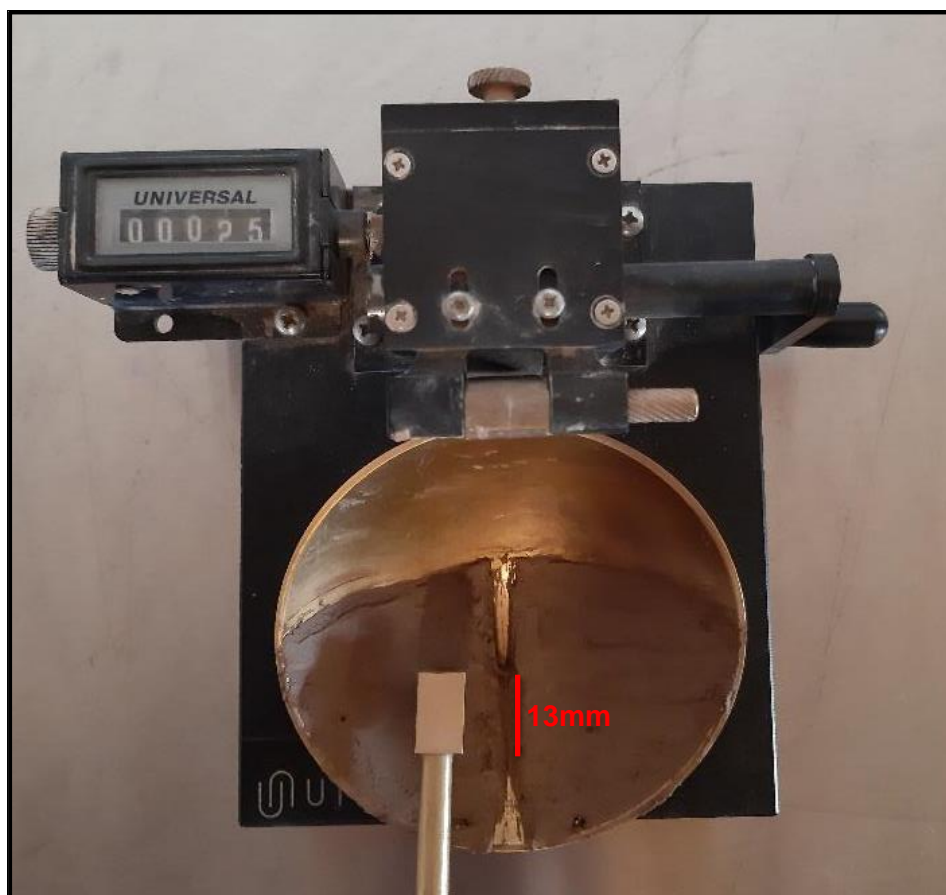
Figura 12: Ensayo para determinar el límite líquido donde se ve el cierre de 13 mm de la ranura.
