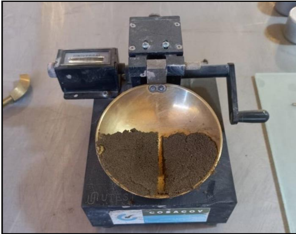
Figura 11: Ensayo de límite líquido donde se puede ver la muestra colocada en la taza del cascador de Casagrande y la ranura realizada.
