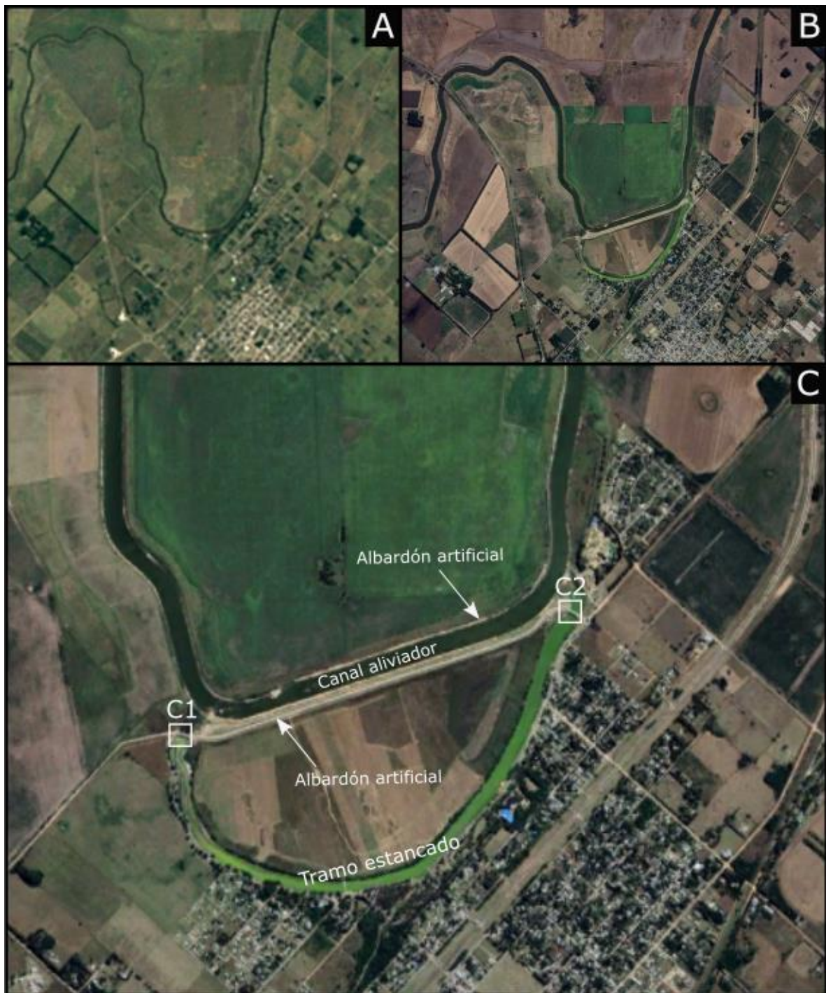
Figura 35: A) Morfología natural del río previa a la construcción del sistema de compuertas (Imagen Landsat/Copernicus del año 1985, tomada de Google Earth). B) Imagen satelital Landsat/Copernicus del año 2023 (tomada de Google Earth) posterior a la obra. C) Detalle de la imagen B donde se muestran los cambios geomorfológicos a grandes rasgos como consecuencia de la construcción (C1: Compuerta N° 1; C2: Compuerta N° 2).
