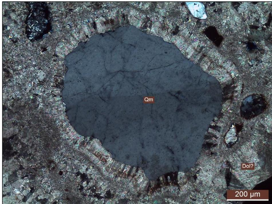
Figura 6.36. Corte delgado con nicols cruzados, se observa cuarzo monocristalino (Qm) inmerso en cemento carbonático tipo *bladed*, microesparita y mosaico granular.
