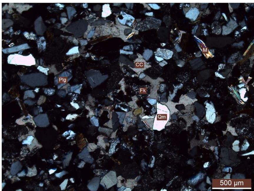
Figura Anexo 8. Vista corte delgado con nicoles cruzados, Plg: Plagioclasa, Fk: Feldespato potásico, Qm: Cuarzo monocristalino, M: Mica, CC: Cemento carbonatico.
