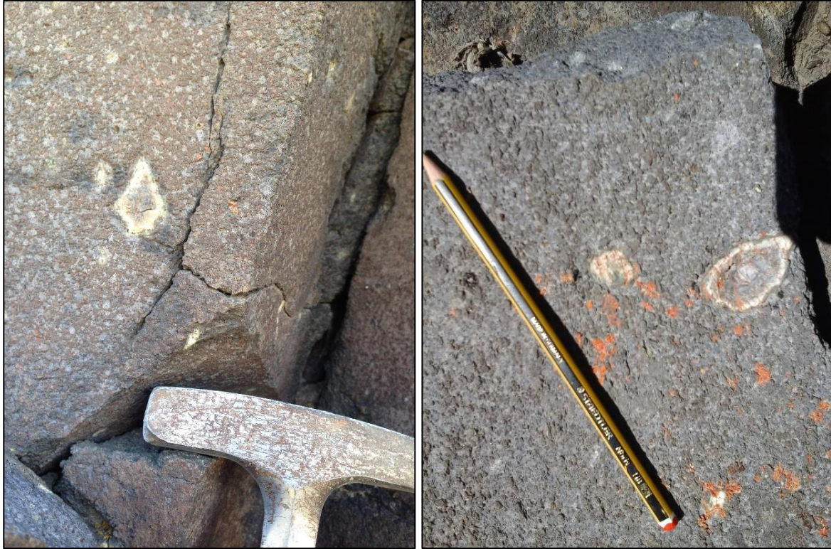
Figura 37. Basaltos con xenolitos de coloración grisácea (15mm - 20 mm), presentan rebordes homogéneos de color blanco con espesores de hasta 5 mm.
