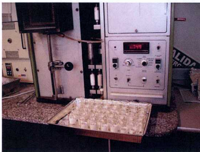
Figura 3.17. En esta foto se observa el aparato utilizado para medir el contenido de carbono total (COT) de las muestras.
