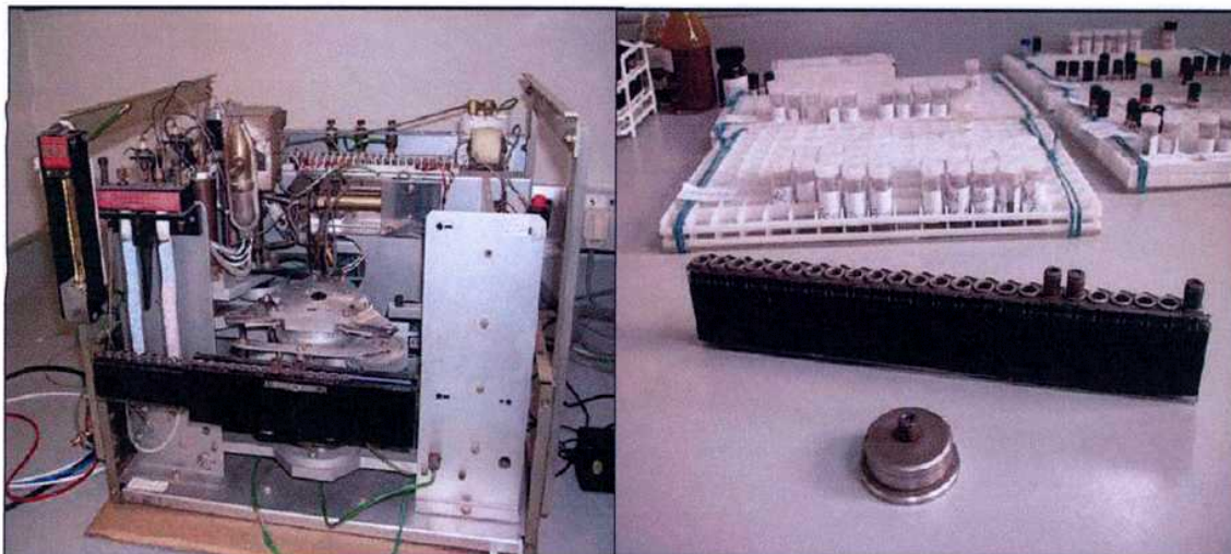
Figura 3.18. En esta foto se observa el aparato utilizado para las mediciones de pirólisis de las muestras.
