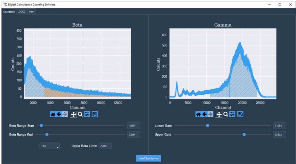
Figura 3.1: Interfaz de la ventana “Spectra” mostrando los espectros \beta (izquierda) y \gamma (derecha) con los controles interactivos para la selección del rango de eficiencia y la ventana de energía gamma.
