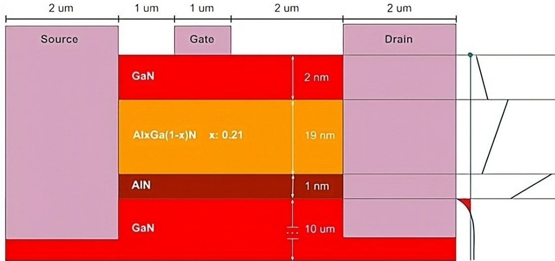
Figura 1.6: Heteroestructura de nuestro transistor. Ninguna de las bandas se encuentra intencionalmente dopada. A la derecha de la imagen se encuentra su diagrama de bandas cualitativo.
