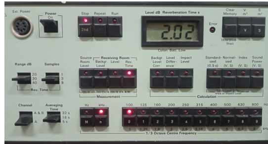
Fig. 4.4: panel frontal del BAAAn. Se muestra configurado el modo de medición de tiempo de reverberación habiendo finalizado una medición de 2,02 s a 1 kHz, obtenida a partir del promedio de 3 mediciones en un rango de caída de 30 dB.
