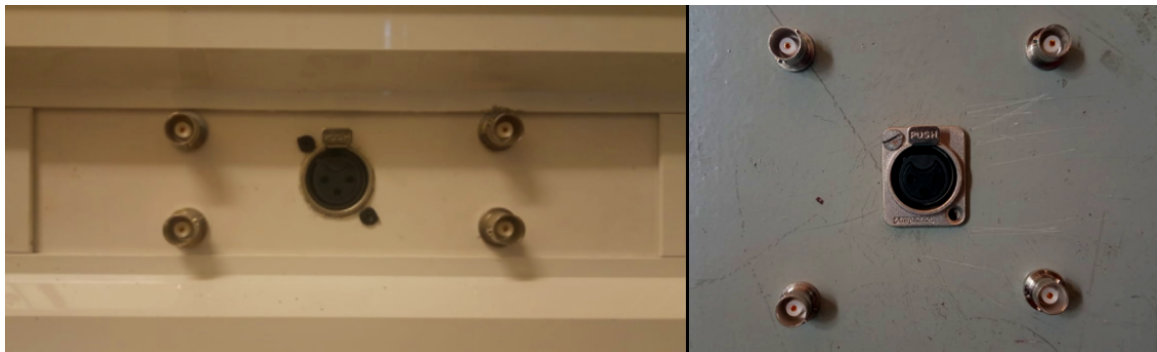
Fig. 4.2: bornera de la cámara de transmisión (izquierda) y bornera de la cámara reverberante (derecha). En el centro de ambas conector XLR hembra y por fuera 4 conectores BNC hembra. Los conectores BNC que se encuentran en la misma ubicación con respecto al conector XLR están conectados entre sí.
