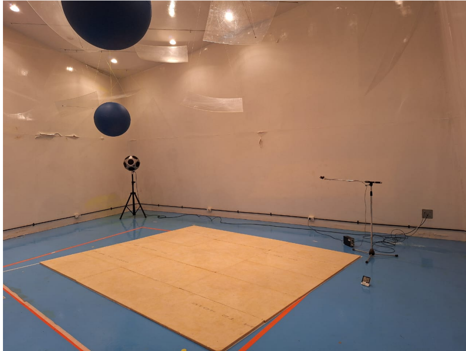
Fig. 4.13: cámara reverberante con la configuración final adoptada para los difusores, sobre el piso se monta una muestra de Andina PVC Rústico de la marca Isover .
