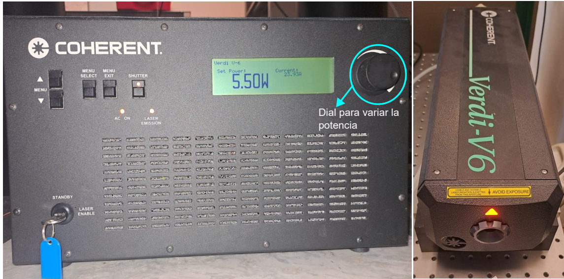
Figura 2.1: Fuente y cabezal del láser de bombeo Verdi V6.
