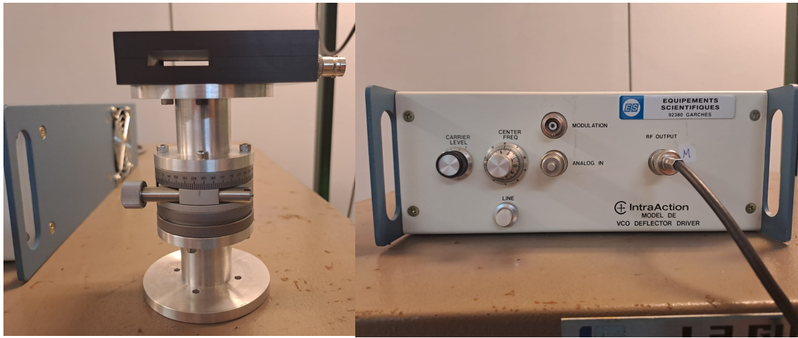
Figura 3.12: A la izquierda, se observa el modulador acusto-óptico utilizado en el lazo de control de la f_0 montado sobre una mesa rotatoria y a la derecha, su controlador.
