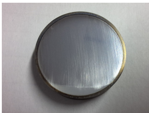
Figura 3.10: Muestra típica recubierta de multicapa Cr – CrN
