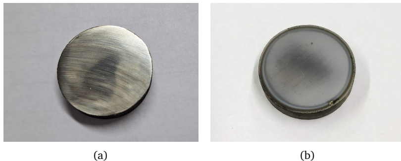
Figura 2.2: Superficie de un sustrato AISI 4140 antes (a) y después (b) de un tratamiento de nitruración.
