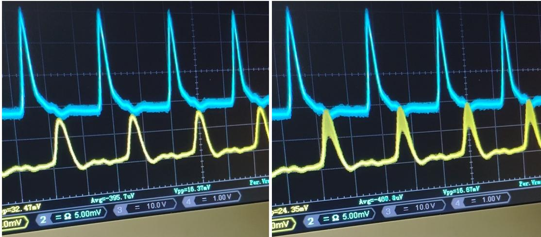
Figura 2.10: Fotografía a modo de ejemplo para distinguir el batido en la señal (amarillo) cuando los brazos no están equilibrados (izq.) y cuando se logra el patrón de interferencia (der.).
