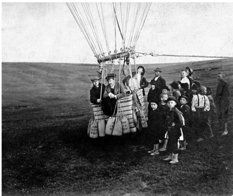
**Figura 1.1:** Estudio de radiación en función de la altitud por Victor Hess. Entre 1911 y 1912, Victor Hess realizó una decena de viajes en globo aerostático para medir la radiación en la atmósfera terrestre. La foto lo muestra a Hess antes de un ascenso hasta cerca de los 4900 m de altitud. Créditos de la fotografía a la *Victor Franz Hess Society*, Schloss Pöllau, Austria.
