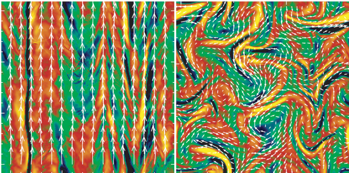
Figura 4.2: Simulación MHD tridimensional en un régimen turbulento con un campo magnético guía en la dirección \hat{z} . La escala de colores representa la densidad de corriente J_z . Las flechas indican el vector campo magnético. A la izquierda se ve un corte en el plano xz del dominio espacial. A la derecha se ve lo mismo pero en el plano xy . La figura fue tomada de [5].
