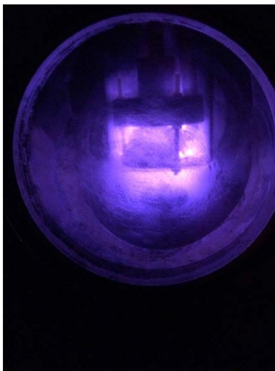
Figura 1: Descarga glow empleada durante la nitruración en aceros por PIII.
