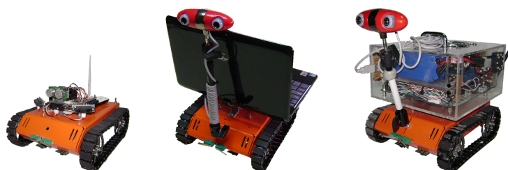
Figura 8: Robot ExaBot, tres de sus configuraciones más utilizadas. De izquierda a derecha, configuración estándar utilizada para el ERBPI, configuración con netbook para visión estereó con algoritmos de visión, y configuración con módulo de GPU para procesamiento de alto rendimiento de video e imágenes.
