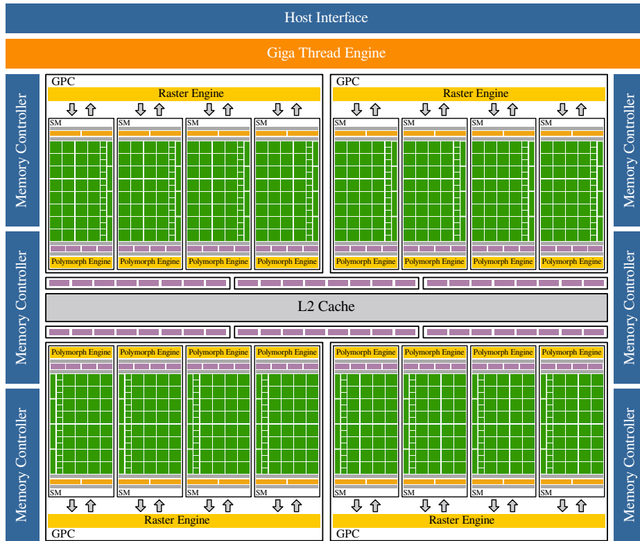
Fig. 2.7: Diagrama de bloques de GF100 Fermi. Tomado de [14].
