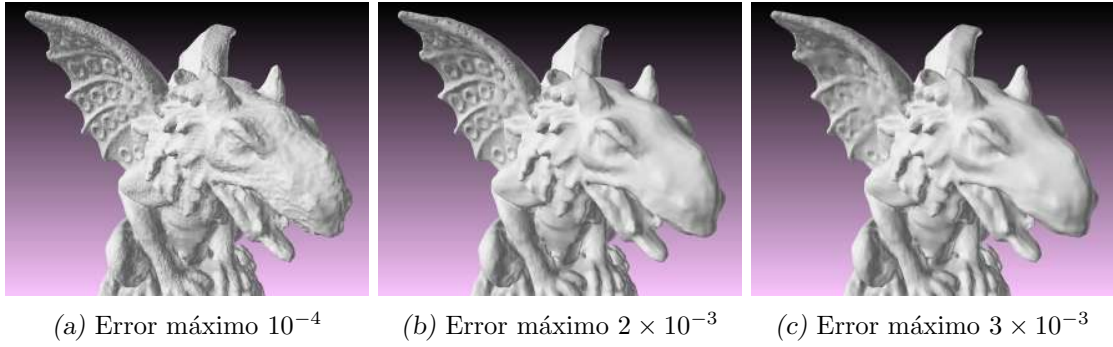
Fig. 4.6: Comparación de reconstrucciones de Gargoyle utilizando el parámetro de error original de 10^{-4} , el alternativo de 2 \times 10^{-3} y uno un poco más permisivo de 3 \times 10^{-3} . Tanto (b) como (c) suavizan el ruido observable en (a), pero (c) ya pierde detalles notables como los círculos en el ala.
