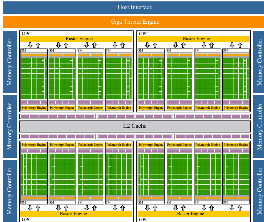
Fig. 2.3: Diagrama de bloques de GF100 Fermi. Tomado de [10].
